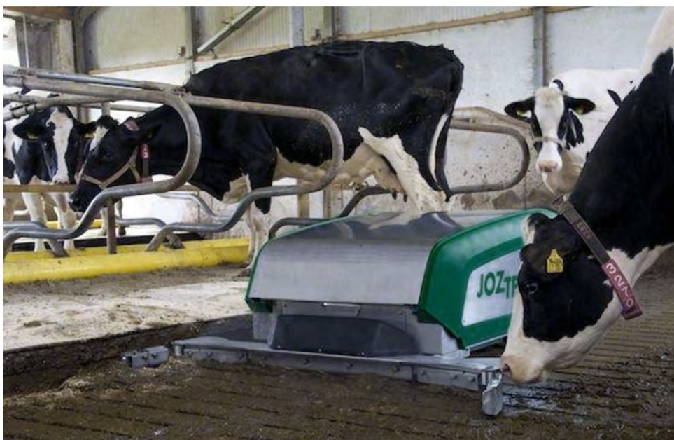
Obr. 3: Automatický odklíz kejdy ve stájovém prostředí chovu skotu
