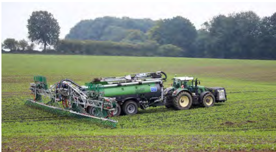
Obr. 26: Technika pro aplikaci okyselené kejdy
