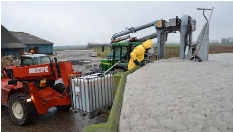
Obr. 16: Okyselování kejdy v kejdové jímce
