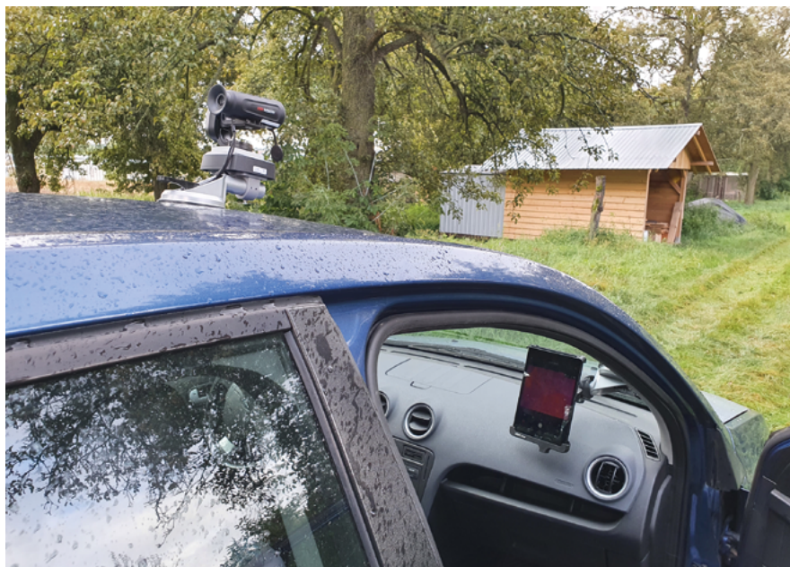
Obr. 29: Termovizní monokulár nainstalovaný na autě
