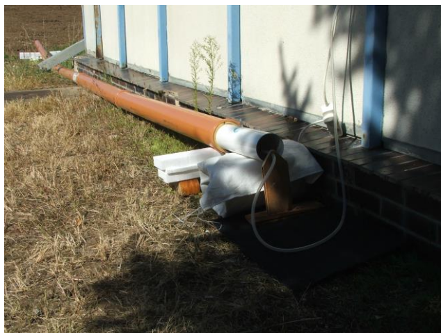
Obr. 6.1. Instalace měřicího zařízení pro zjištění doby reakce \text{NH}_3 - \text{O}_3
