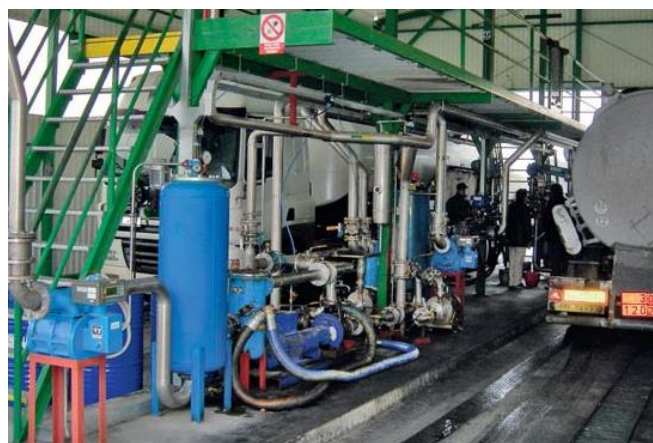
Obr. 5.1. Část ověřovaného zařízení pro kontinuální výrobu směsné motorové nafty a její expedici v Agropodniku, a.s. Dobronín
