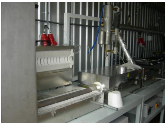
Obr. 1 Pohled na vytápěnou sekci trubkového reaktoru se šnekovnicí vývojové zkušební linky dvoustupňové termolýzy s výkonností do 2 \text{ kg.h}^{-1} vstupní suroviny v PolyComp, a.s. Poděbrady
