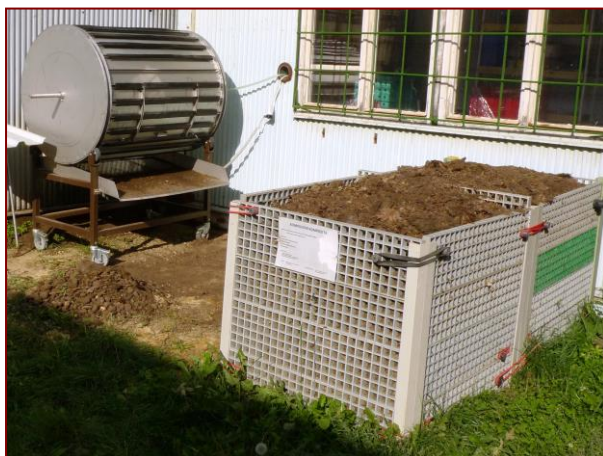
Obr. 10.1. Experimentální pracoviště pro ověřování kompostérů
