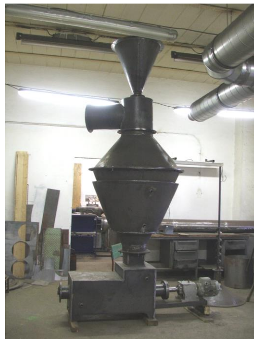
Reaktor určený pro ověřování velmi rychlého tepelného rozkladu biomasy
