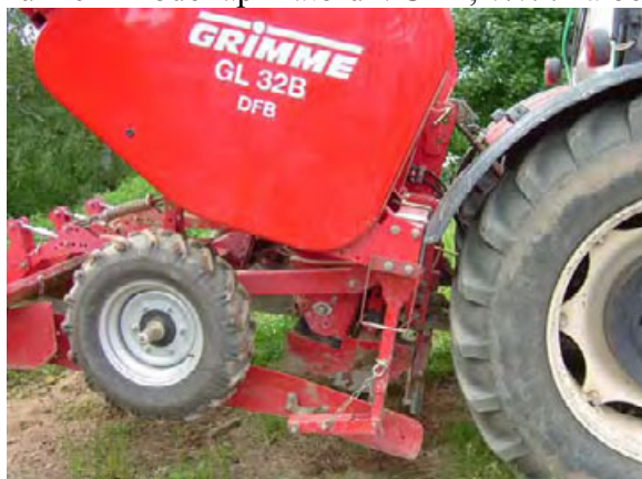
Obr. 2.1 Konstrukční úprava VÚZT, v.v.i Praha, pro aplikaci kapalného hnojiva pod hlízu na dvouřádkovém sázeči brambor Grimme
