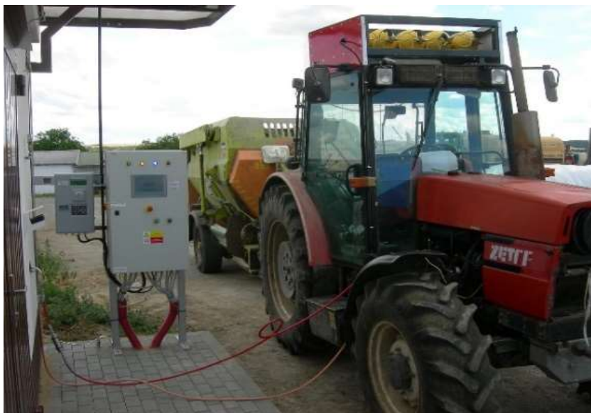
Obr. 7: Plnění traktoru ZETOR 10540 (FM) DUÁL stlačeným plynem na pilotním plnicím zařízení
