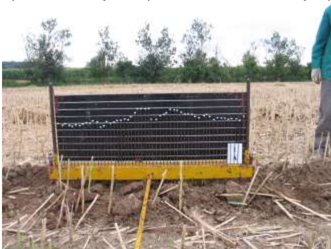
Obr. 16: Příklad měření podélného profilu povrchu nakypřené půdy pomocí profilografu ve variantě s 2 dláty
