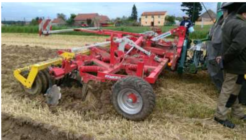
Obr. 22: Měření sil v tříbodovém závěsu
