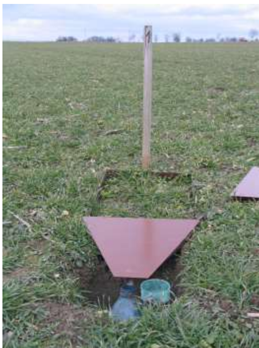
Obr. 9: Sběrač povrchového odtoku vody instalovaný na plochu pokusu po vzejití pšenice ozimé
