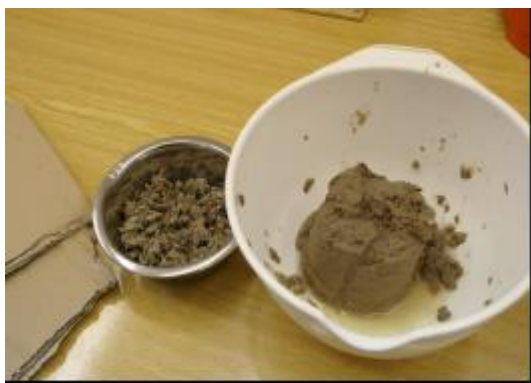
Obr. 46 Porovnání tvaru a konzistence lepenky po mixování
