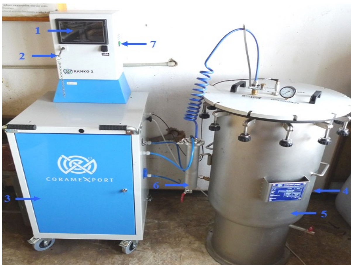
Obr. 23 Stanovování stability kompostu v laboratoři (foto: P. Plíva)
