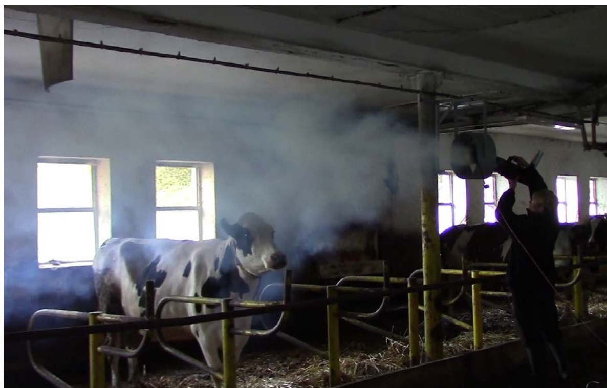
Obr. 29 Průběh kouřové zkoušky po nainstalování ventilátorů
