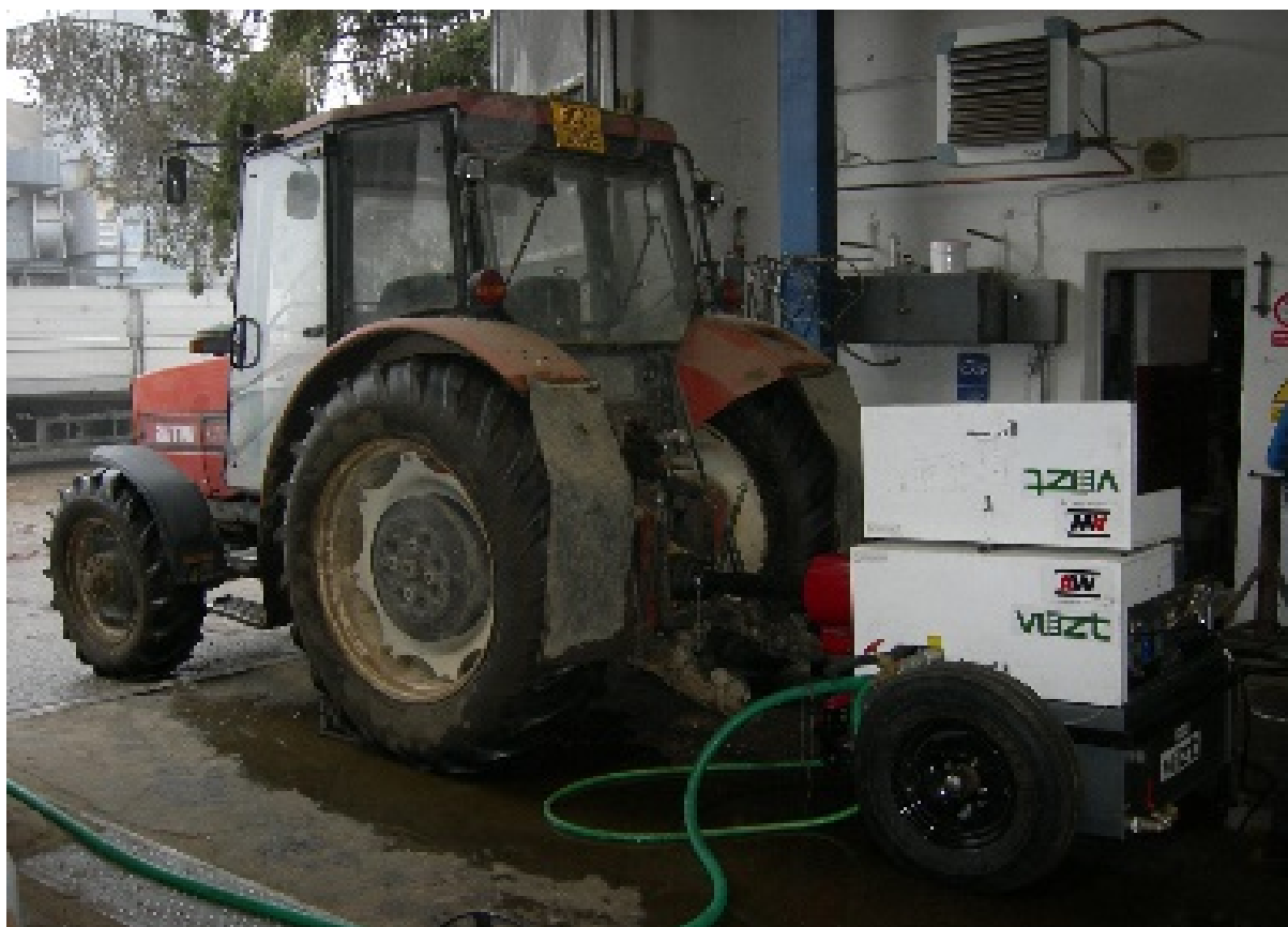
Obr. 36 Měření vnějších otáčkových charakteristik a spotřeby testovaných paliv
