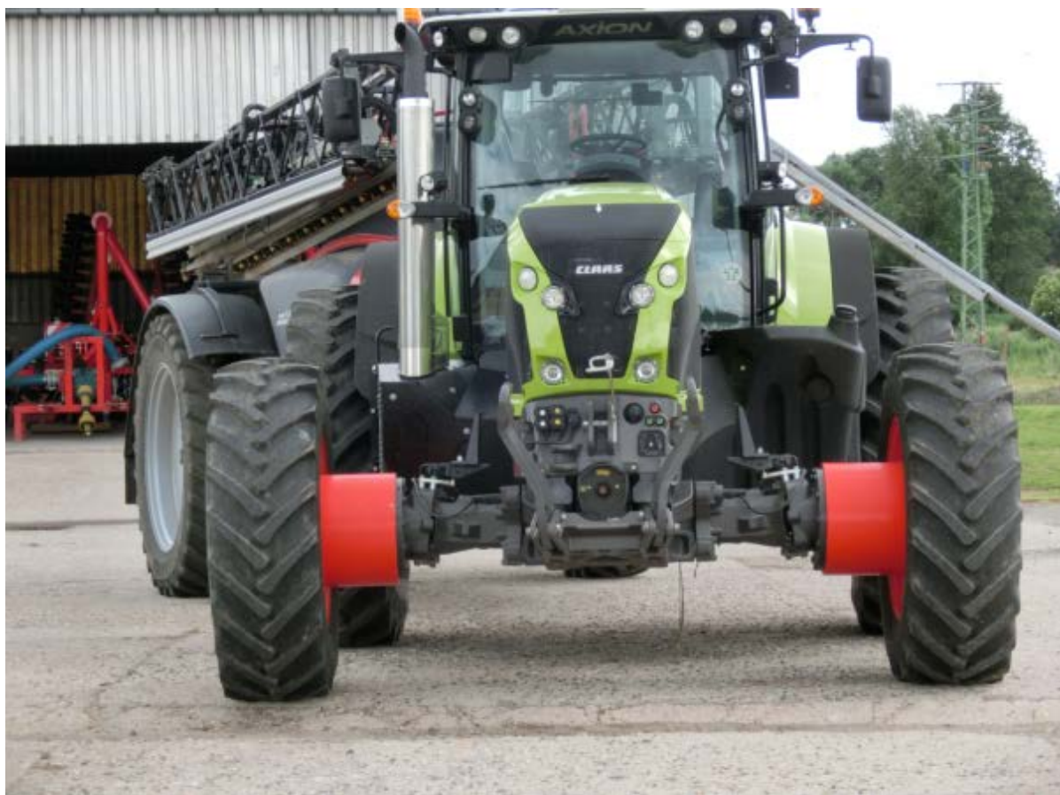
Obr. 5 Technicky náročné sjednocení rozchodu kol a pásů pro systém řízených přejezdů (AgroVation Kněžmost)
