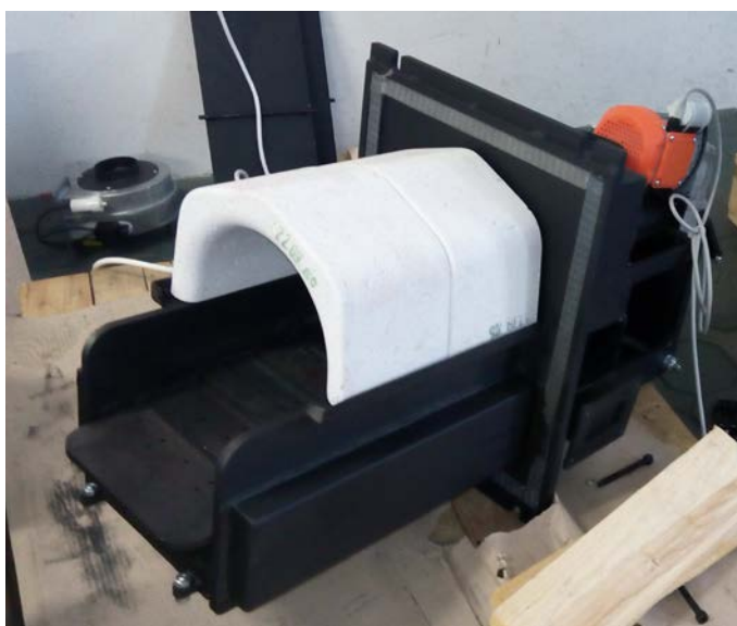
Obr. 27 Pohled na ocelovou a žárobetonovou muldu
