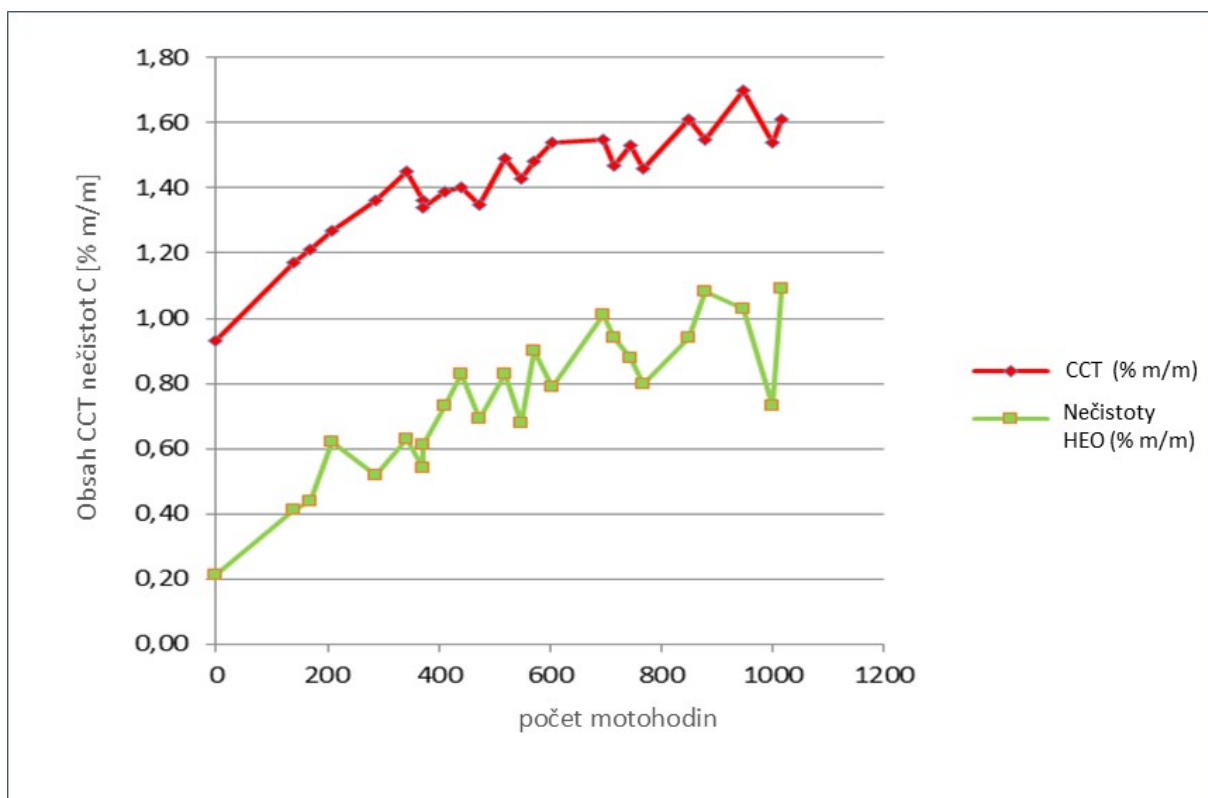
Obr. 33 Závislost Conradsonova karbonizačního zbytku (CCT) a obsahu nečistot na počtu motohodin v oleji 15W/40 – ZETOR 9540, palivo SMN R31
