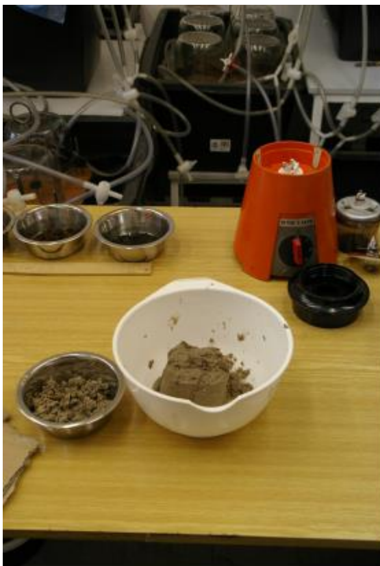
Obr. 45 Papírová lepenka rozvlákněná za mokra v mixéru
