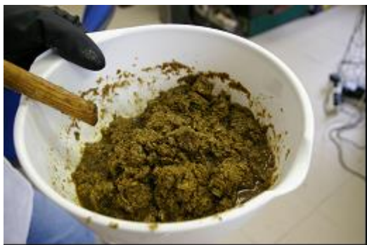
Obr. 49 Slaměné pelety rozpuštěné ve vodě
