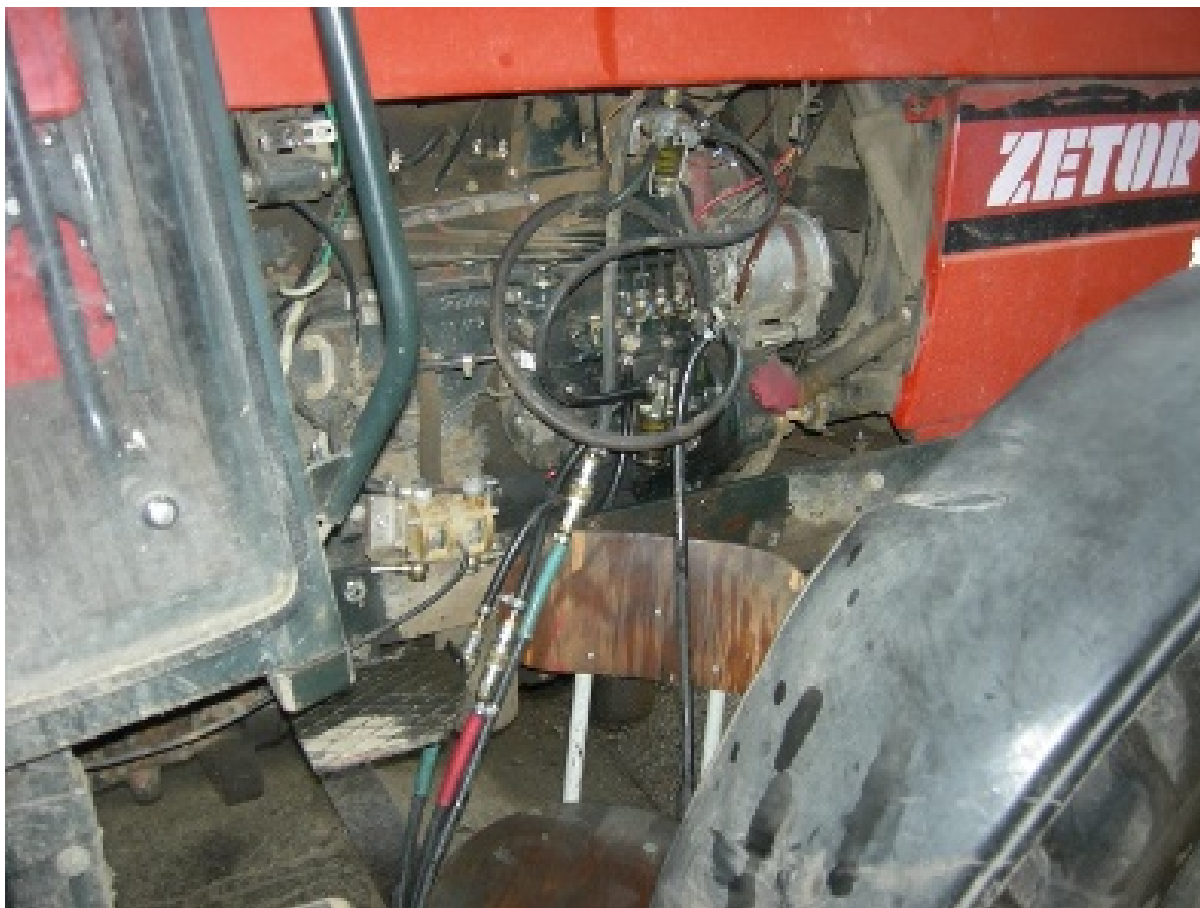
Obr. 37 Systém napojení palivového boxu s průtokoměrem Macnaught M2ASP-1R na palivový systém zkoušeného traktoru ZETOR 10540
