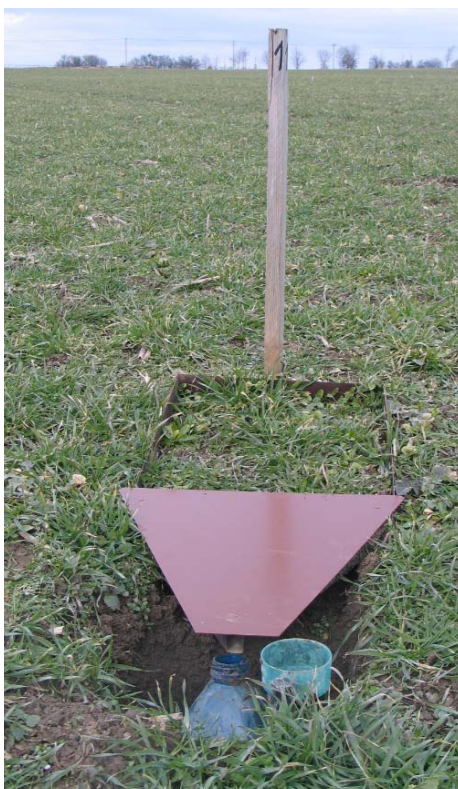
Obr. 6: Minisběrač s plochou 0,2 m 2 nainstalovaný do vzešlého porostu
