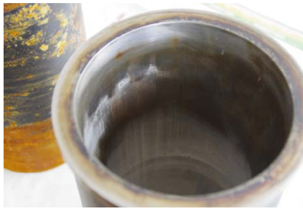
Obr. 16: Vložka válce motoru s náznaky zadírání pístu
