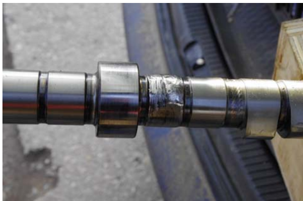
Obr. 15: Mechanické poškození vačkové hřídele způsobené zadíráním zdvihátka
