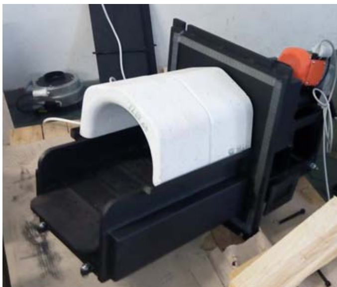
Obr. 17: Hořák s posuvnými roštnicemi
