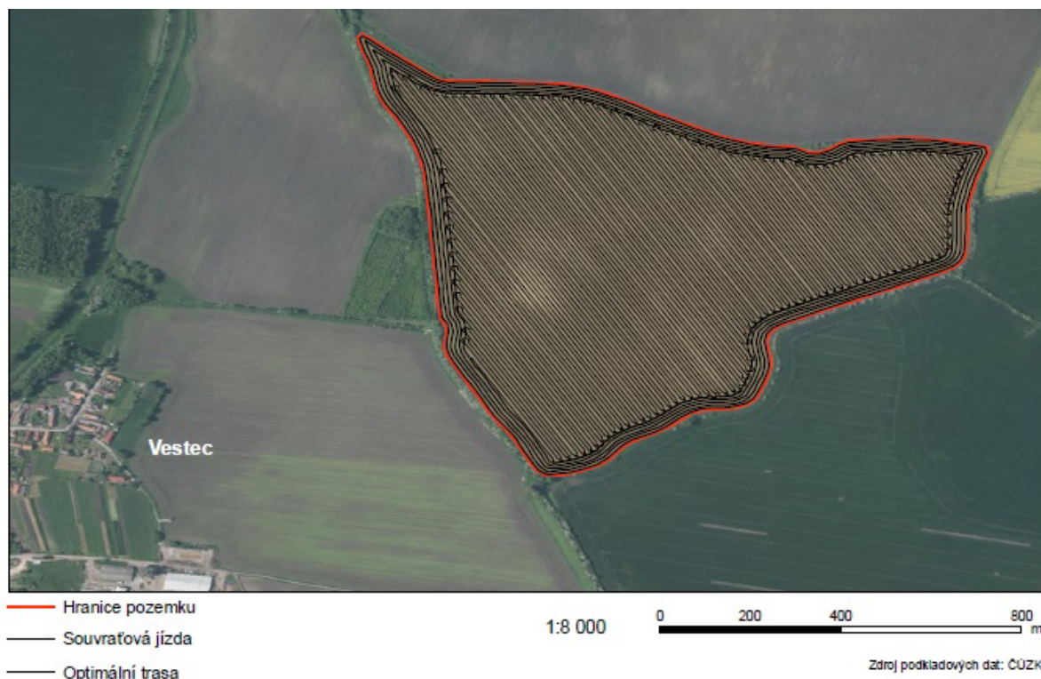
Obr. 11: Návrh trasy pohybu strojních souprav při pracovním záběru 6 m, včetně souvratí – pozemek s nepravidelným tvarem
