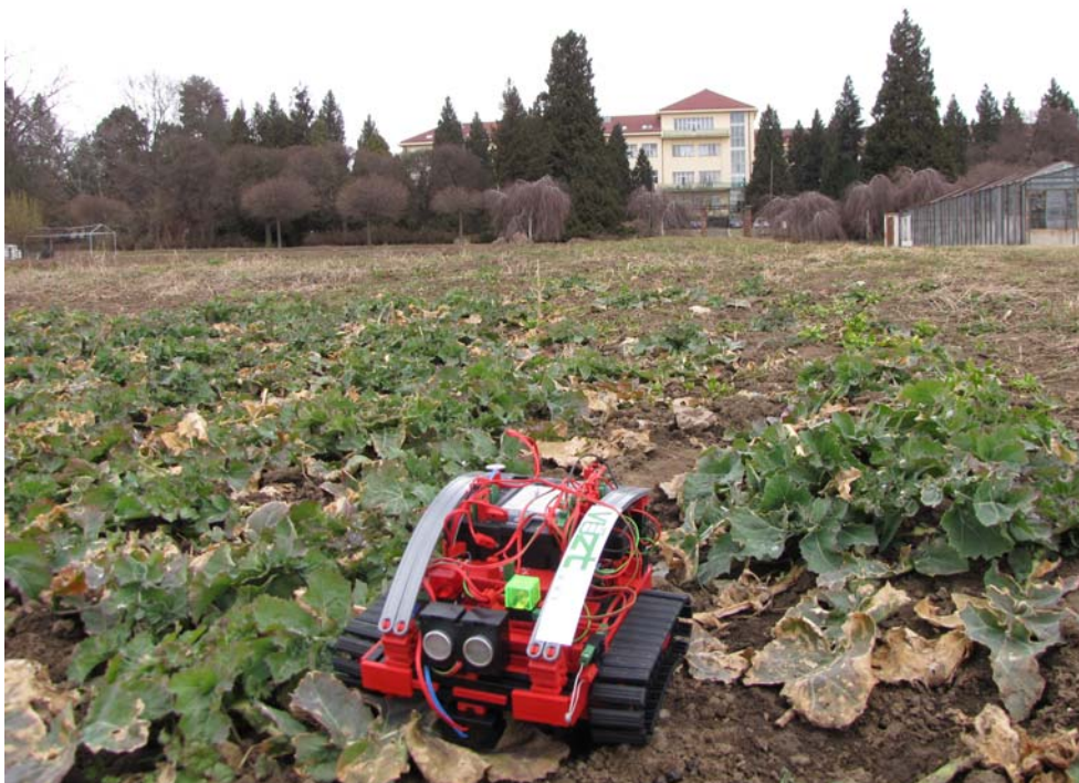
Obr. 2: Robotická stavebnice pro testování aplikací a senzorů
