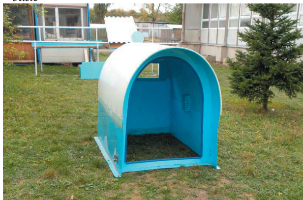
Obr. 2: VIB pokryta 3 vrstvami izolace pod plovoucí podlahou krytých bílým PP plastem, varianta 2
