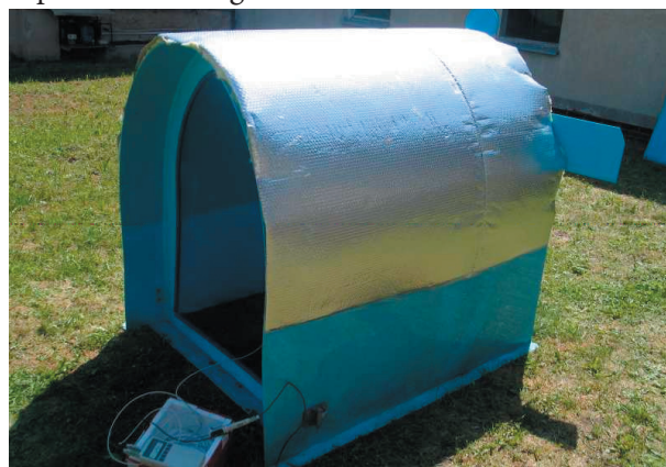
Obr. 3: VIB pokryta 50mm vrstvou minerální vaty a AB parozábranou s hliníkovou fólií, varianta 3
