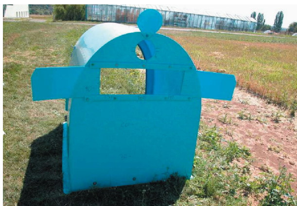
Obr. 1: VIB bez pokryvu, větrání otevřeno, varianta 1 – základní
