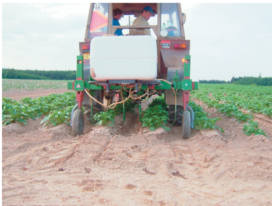
Obr. 2: Přihnojování polních pokusů přesnou aplikací kapalných hnojiv ke kořenům hlíz do půdy během vegetace Fig. 2: Supplementary fertilization of field trials by exact application of liquid fertilizers into the soil to the tuber roots during the vegetation season
