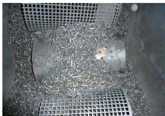
Obr. 17 Pohled na karbonizované pelety pšeničné slámy v termolýzním reaktoru zkušební linky TKKA ZKL
