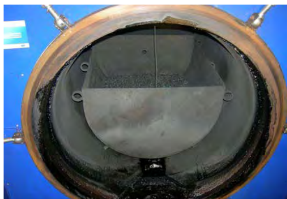
Obr. 16 Carbonizované pelety pšeničné slámy před jejich expedicí z termolýzního reaktoru zkušební linky TKKA ZKL
