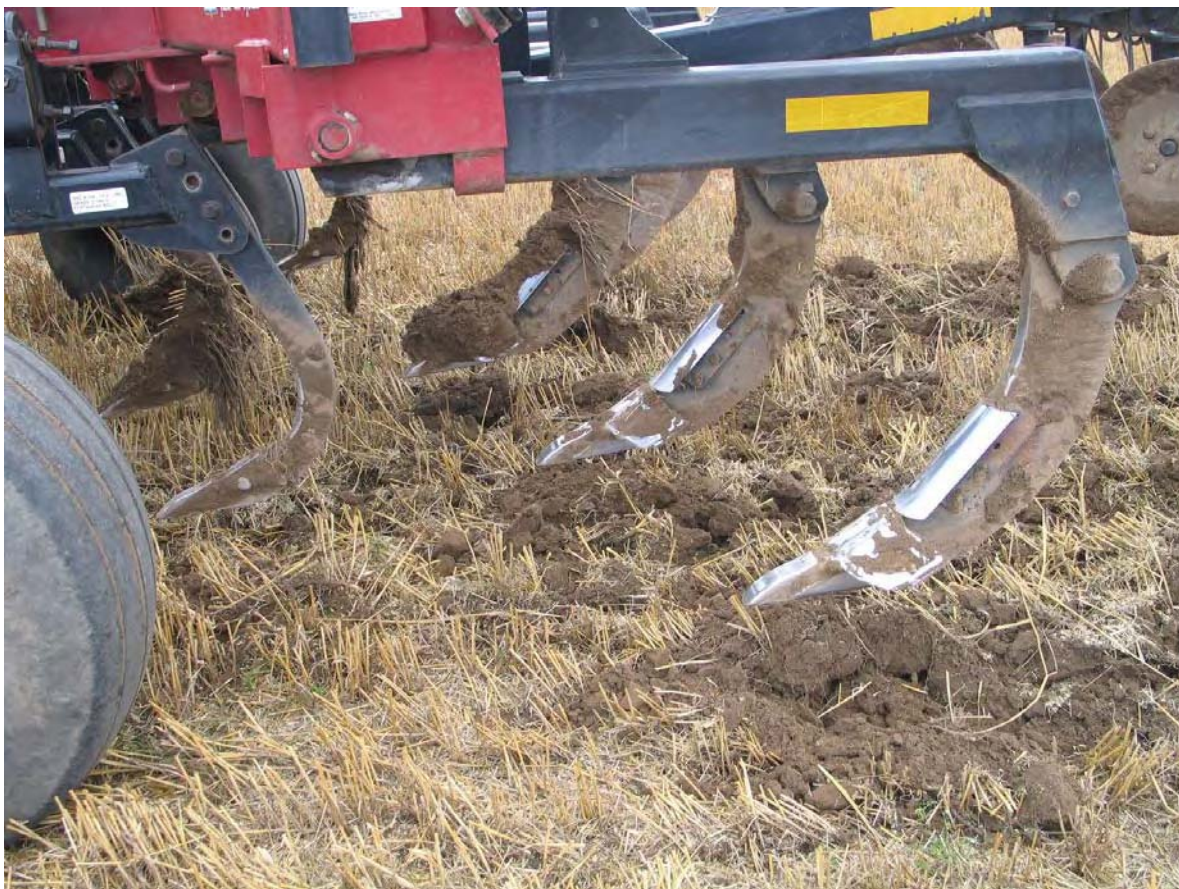
Obr. 3 Dláta kombinovaného dlátového kypříče DMI Ecolo Tigar Fig. 3 Chisels of combined chisel plow DMI Ecolo Tigar
