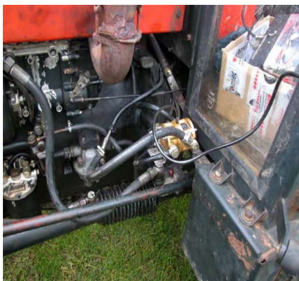
Obr. 3 Průtokoměr upevněný na traktoru Zetor 7711
