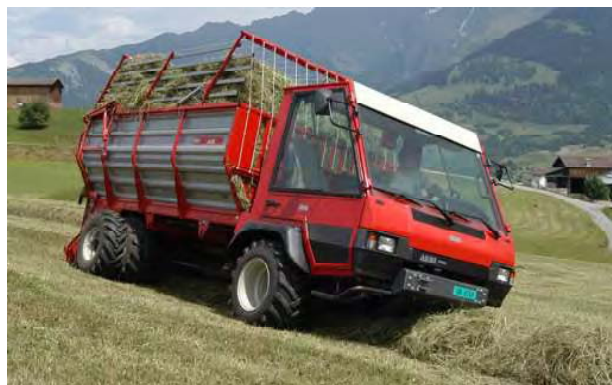
Obr. 3 Samojízdný podvozek Transporter AEBI s velkoobjemovou sběrací nástavbou
