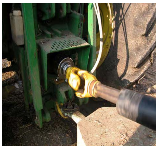
Obr. 4 Tenzometrická hřídel umístěná na traktoru John Deere 6010
