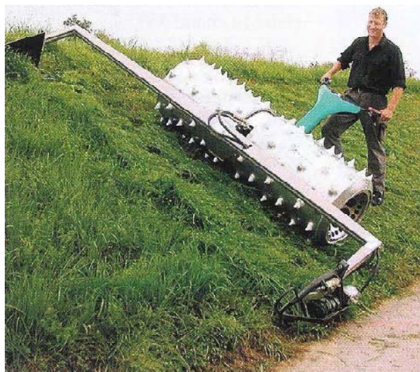
Obr. 4 Speciální konstrukce pojízdného ústrojí s protiběžnou žací lištou
