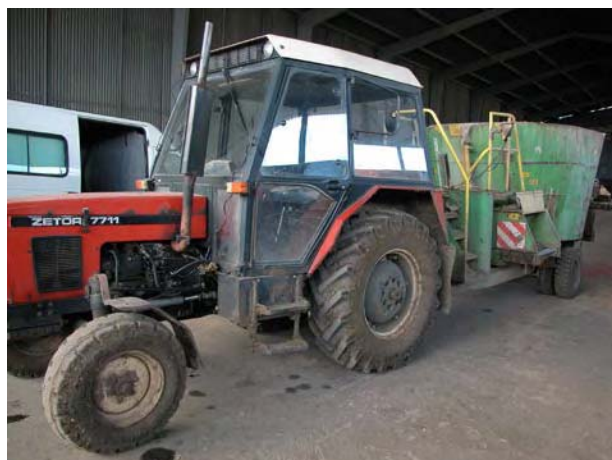
Obr. 2 MKV CERNIN C 6 agregovaný s traktorem Zetor 7711
