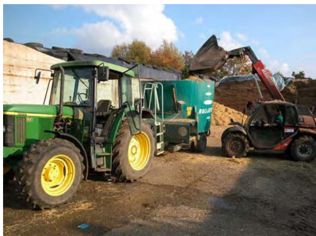
Obr. 1 MKV LUCLAR Rollerfeed 10 agregovaný s traktorem John Deere 6010 při na kládání jednotlivých krmných komponent manipulátorem
