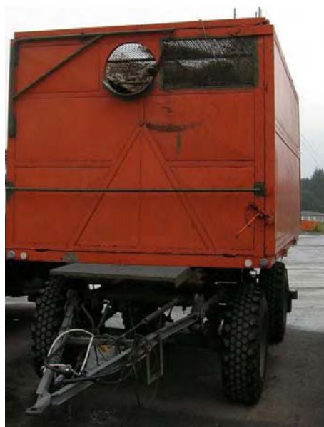
Obr. 1 Velkokapacitní přívěs používaný při sklizni a dopravě trávy Fig. 1 Large-scale capacity trailer used during harvest and grass transport
