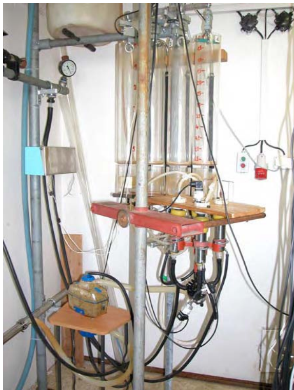
Obr. 1 Měřicí linka na testování dojících souprav Fig. 1 Measuring line for testing of milking sets
