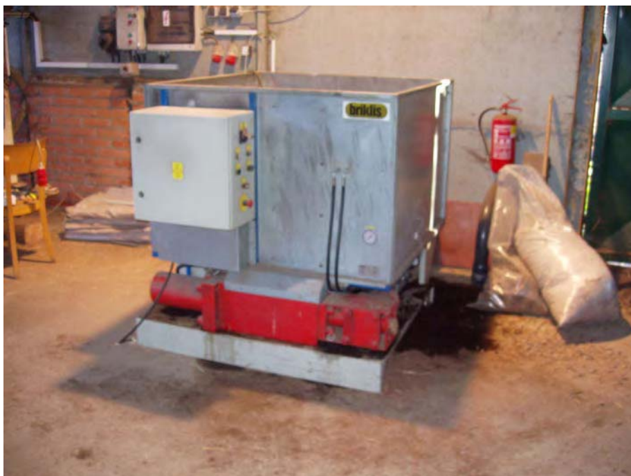
Obr. 4 Briketovací lis HLS 50 Fig. 4 Briquetting press HLS 50
