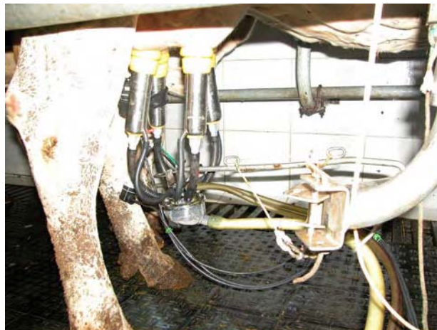
Obr. 2 Dojící souprava osazená čidly podtlaku při provozním měření Fig. 2 Milking set with vacuum sensors at process measurement
