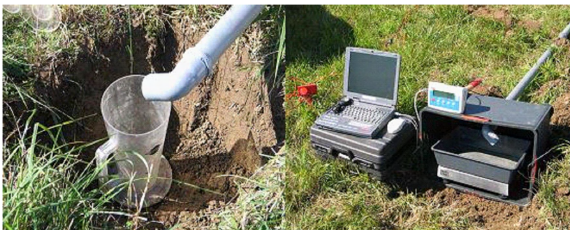
Obr. 1a,1b Původní ruční odečet objemu povrchového odtoku vody pomocí odměrných nádob (vlevo) a zařízení pro jeho měření a vyhodnocení – digitální váhy Radwag WLC6 a PC (vpravo)
