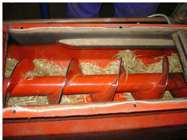
Obr. 2: Podávání paliva do kotle Fig. 2 Fuel feeding in boiler
