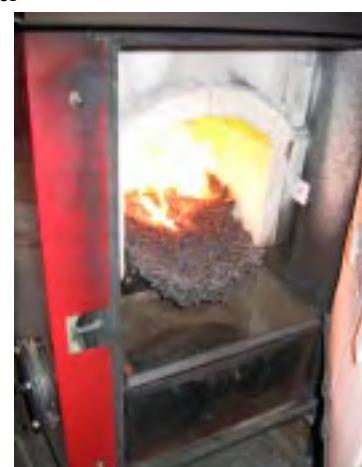
Obr. 7 Pohled na spékání popelovin při spalování granulované slámy
