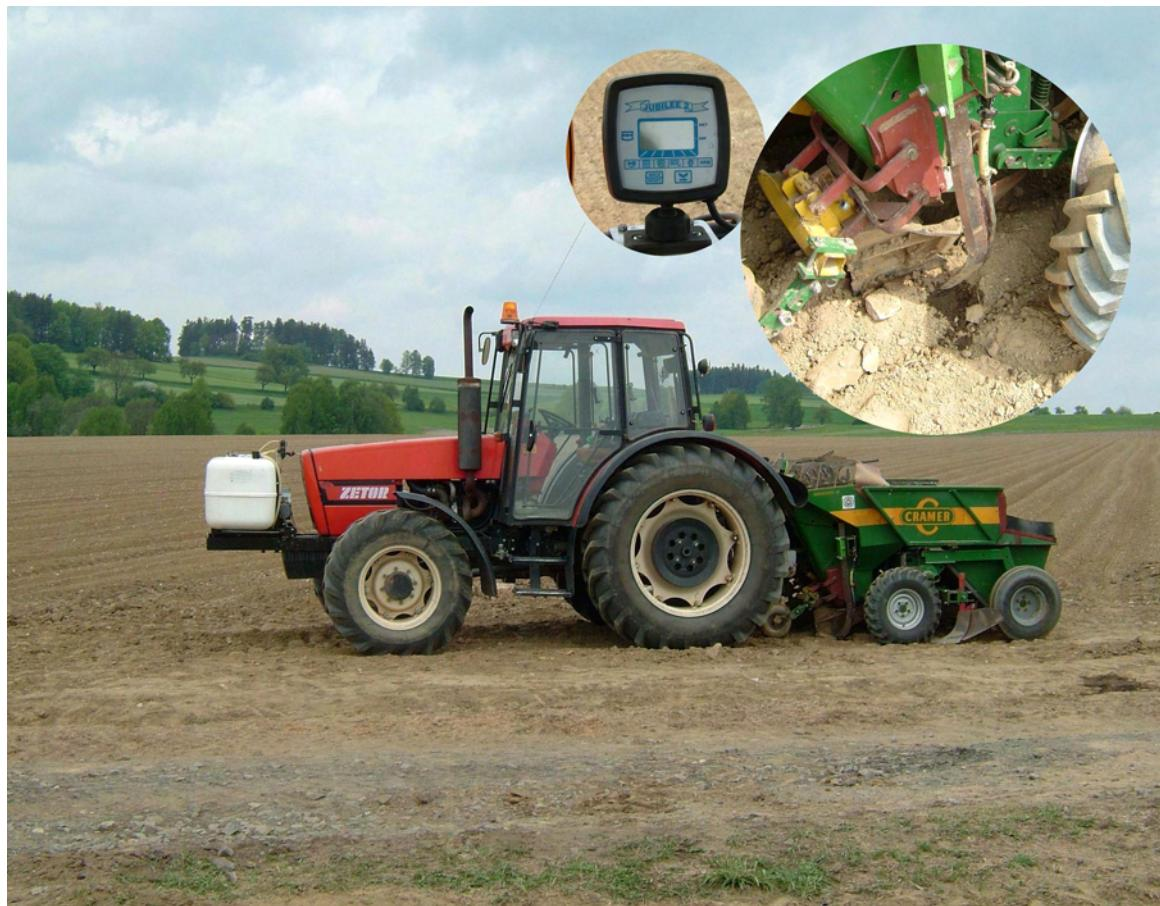
Obr. 1 Funkční model zapravovacího zařízení pro aplikaci kapalných hnojiv (VÚZT Praha.) na sázeči Cramer
