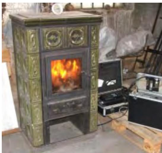
Obr. 1 Spalovací akumulační kamna SK-2
