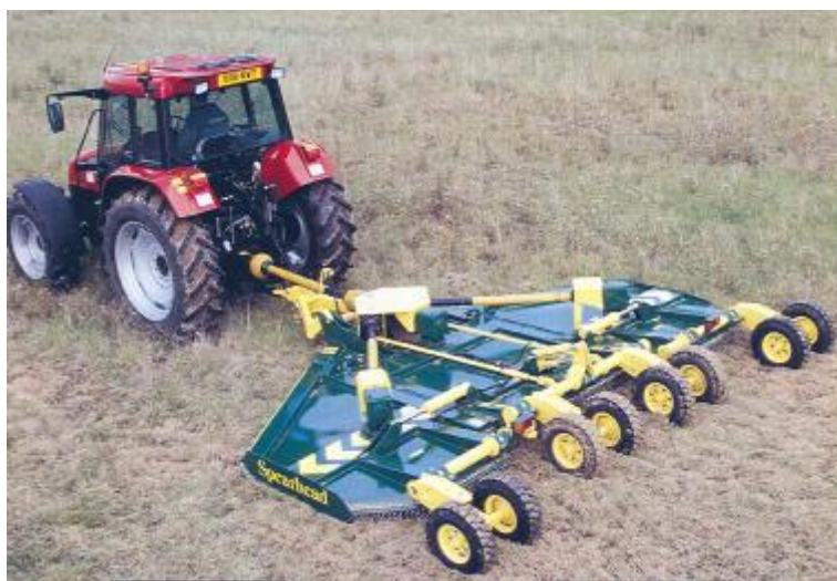
Obr. 2 Ošetřování travních porostů na půdách uvedených do klidu prováděné mulčováním široko-záběrovým mulčovačem
