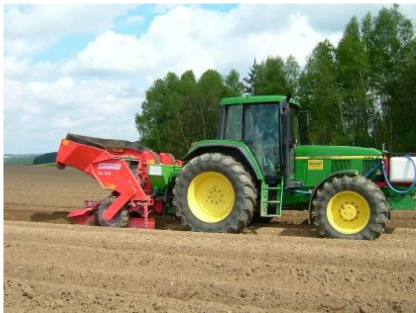
Obr. 3 Sázení s přihnojováním tuhými hnojivy a kapalným mořením
