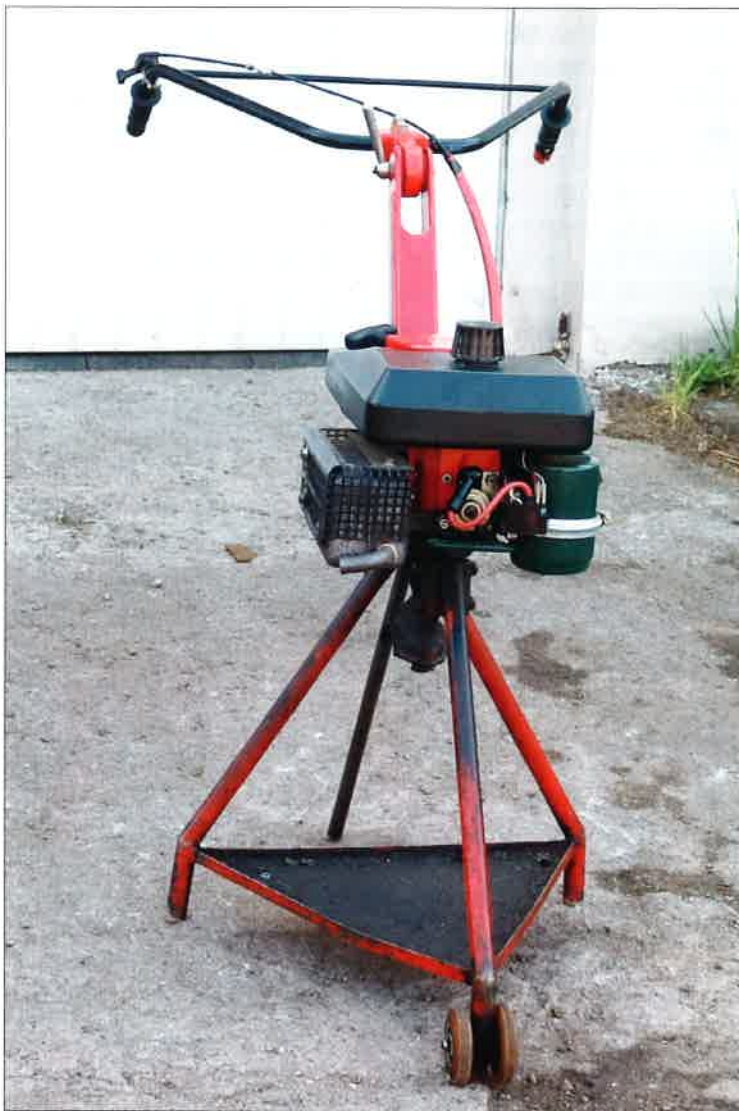
Obr. 1 – Dvoudobý zážehový motor JIKOV 1454 – VAPE
