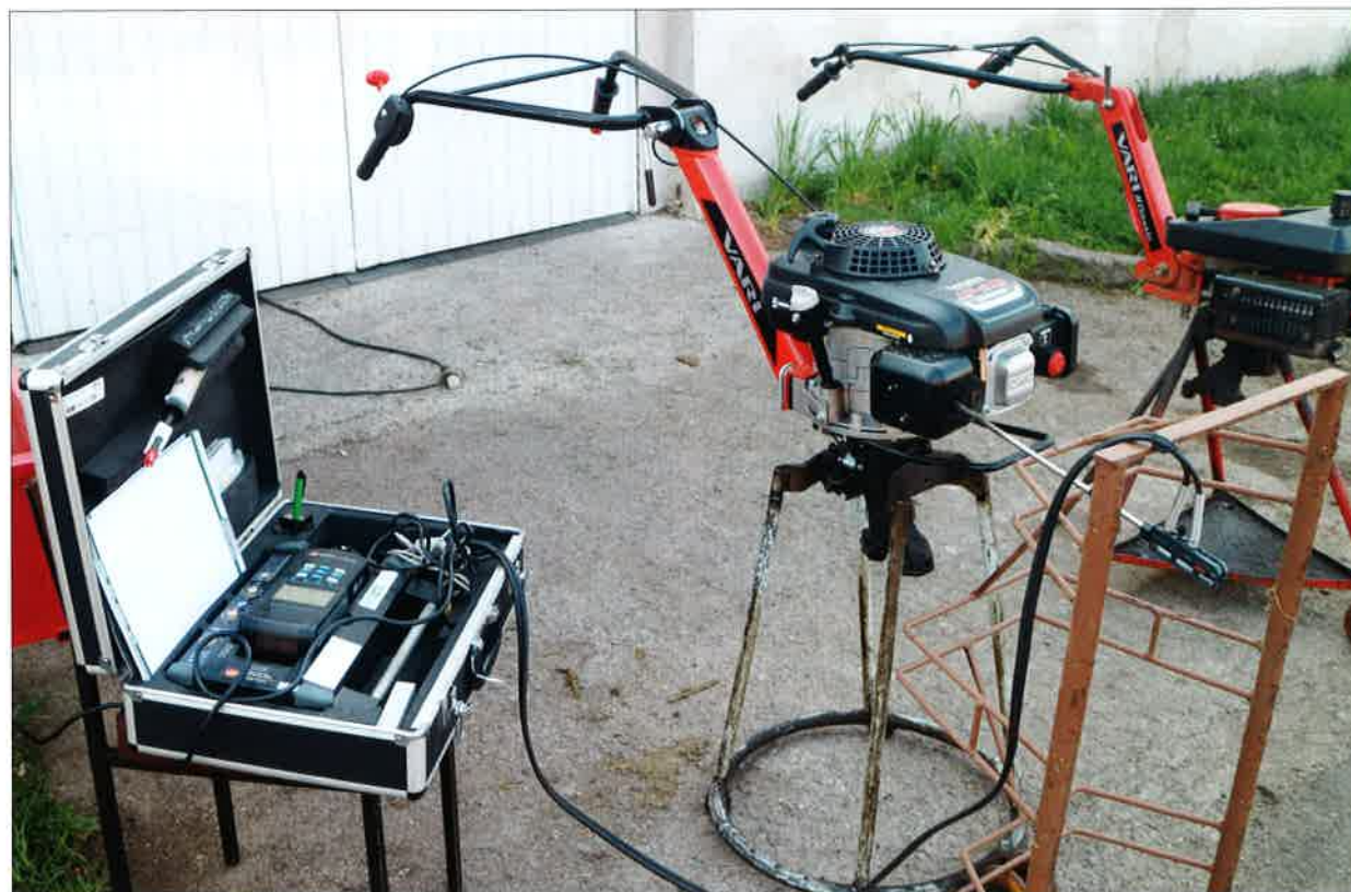
Obr. 3 – Měření emisí při volnoběžných otáčkách bez zátěže
