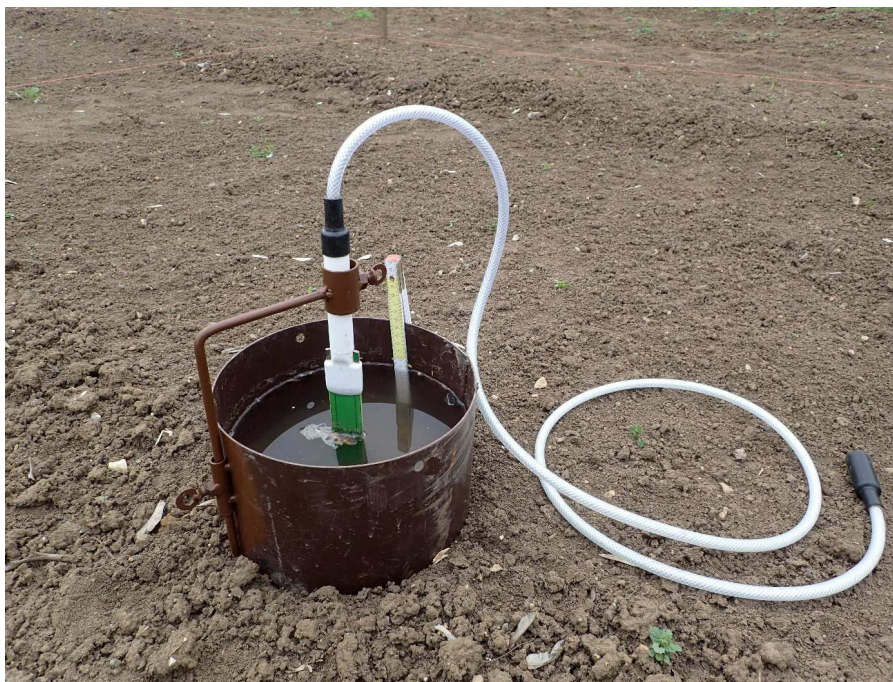
Vlhkoměr TMS3 použitý jako stavoznak výšky hladiny vody v měřicím válci
