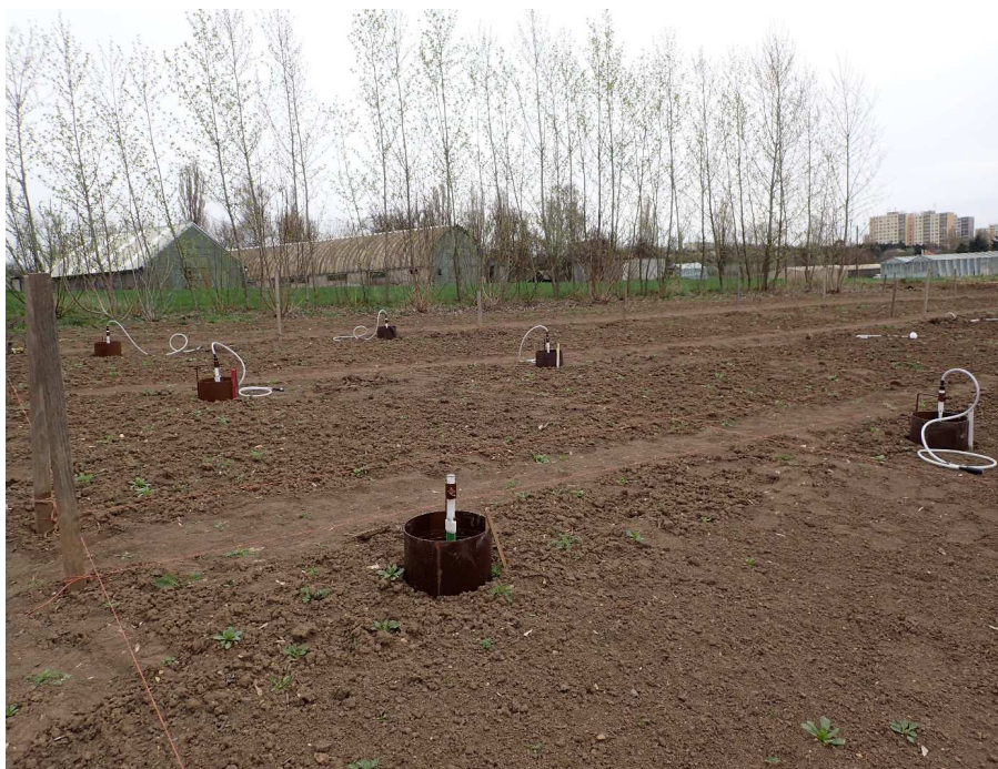
Na 6 variantách pokusu lze měřit hydraulickou vodivost současně
