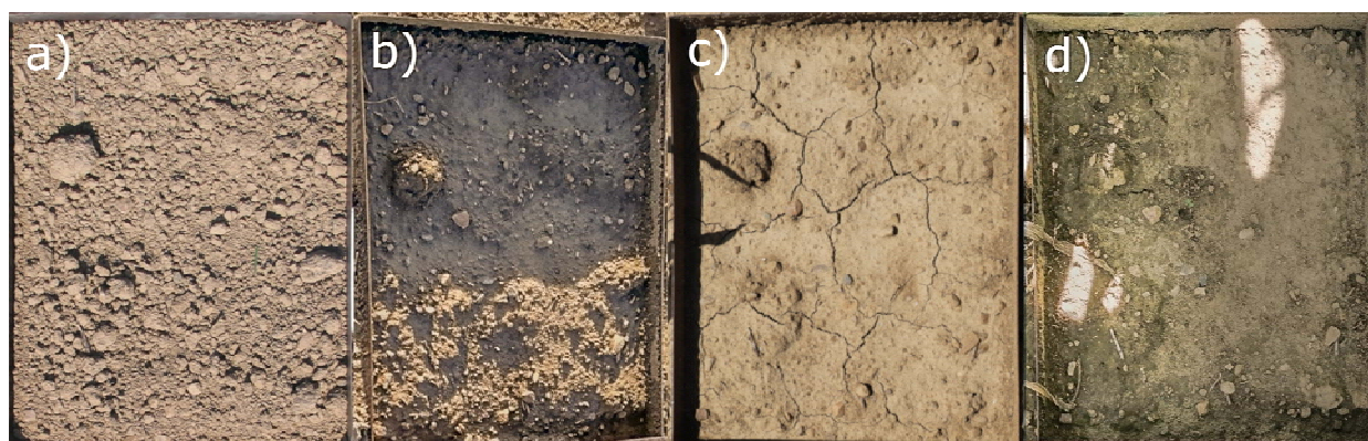
Obr. 8: Změny povrchové struktury půdy ve vybraném minisběrači v průběhu sezóny: a) stav při založení pokusu 6.6.2019, b) 8.6. po dešťové události, c) 14.6. po vyschnutí povrchu, d) 4.9. při ukončení pokusu
