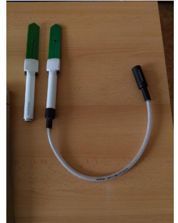
Vlevo vlhkoměr pro odečet hladiny vody ve sběrné nádobě, vpravo vlhkoměr pro podpovrchovou instalaci s kabelem ke čtecí hlavici
