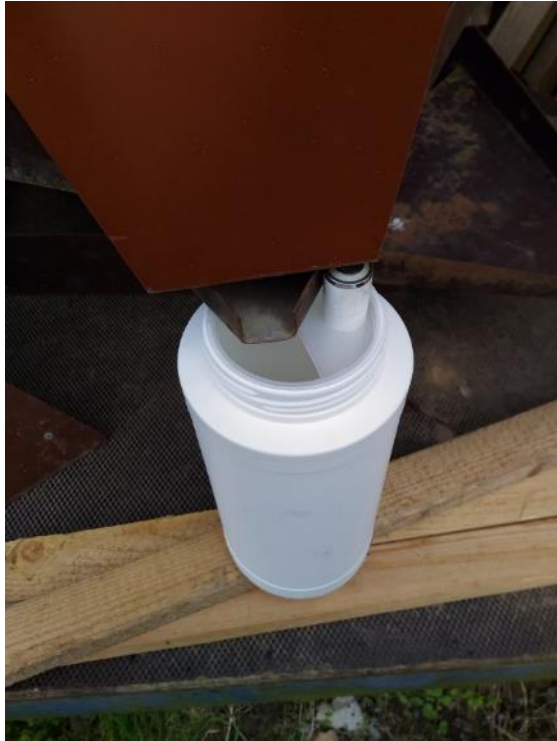
Sběrná nádoba s instalovaným vlhkoměrem pro měření výšky hladiny vody
