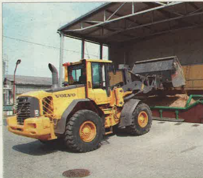
Příjmový zásobník bioplynové stanice je plněn výkonným samojízdným čelním nakladačem
