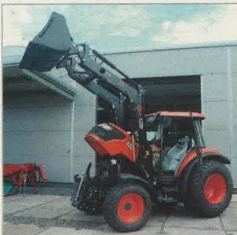
Traktorové čelní nakladače jsou poháněny hydraulikou traktorů. Foto archiv Hauer
