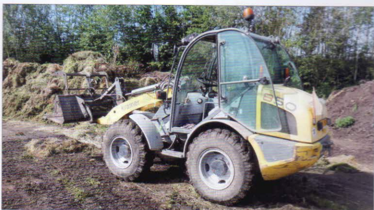
Manipulace se surovinami – univerzální nakladač Kramer Allrad 850 (výkon 45 kW) s objemy lopaty 0,85–1,3 m 3
