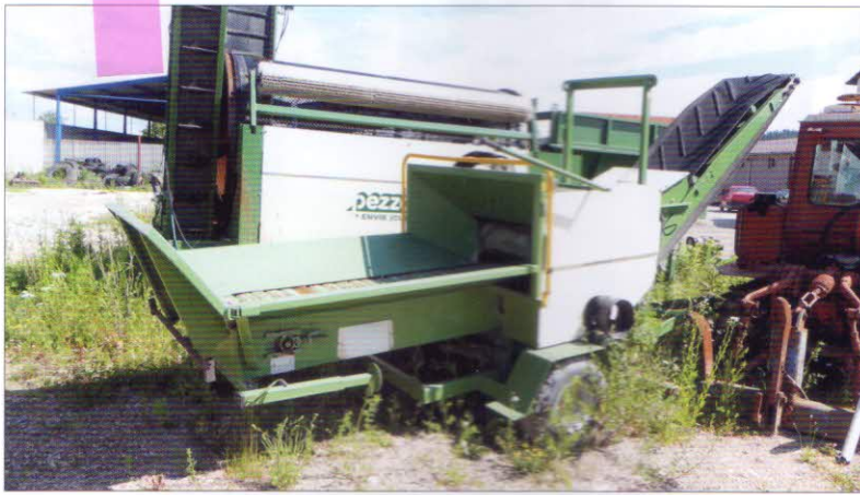
Jemná dezintegrace – drtič dřevní hmoty PEZZOLATO S 7000 (energetický zdroj kolový traktor, průměr dřevní hmoty max. 200 mm). Výkonnost 20 m 3 /h závisí na vlastnostech a množství zpracovávaných surovin)
