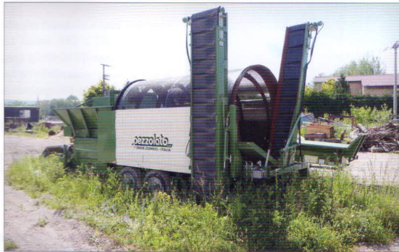
Prosévání vyrobeného kompostu – bubnový třídič PEZZOLATO typ L3000 G poháněný vývodovým hřídelem traktoru. Průměr bubnu 1800 mm, velikost oka síta 25 x 25 mm, výkonnost asi 30 m 3 /h (závisí na vlastnostech a množství proséváných surovin)
