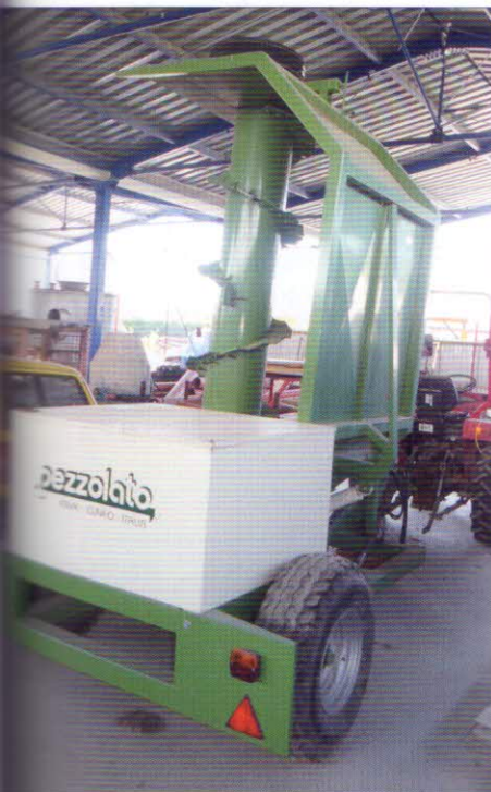
Překopávání kompostu – tažený překopávač kompostu PEZZOLATO PRT 2500 G s kolovým traktorem (výkon minimálně 50 k). Pracovní prostor překopávače 2,5 x 1,4 m, výkonnost zhruba 700 m 3 /h
