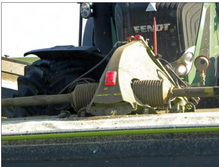
Obr. 55: Umístění piezosirény na žacím stroji
