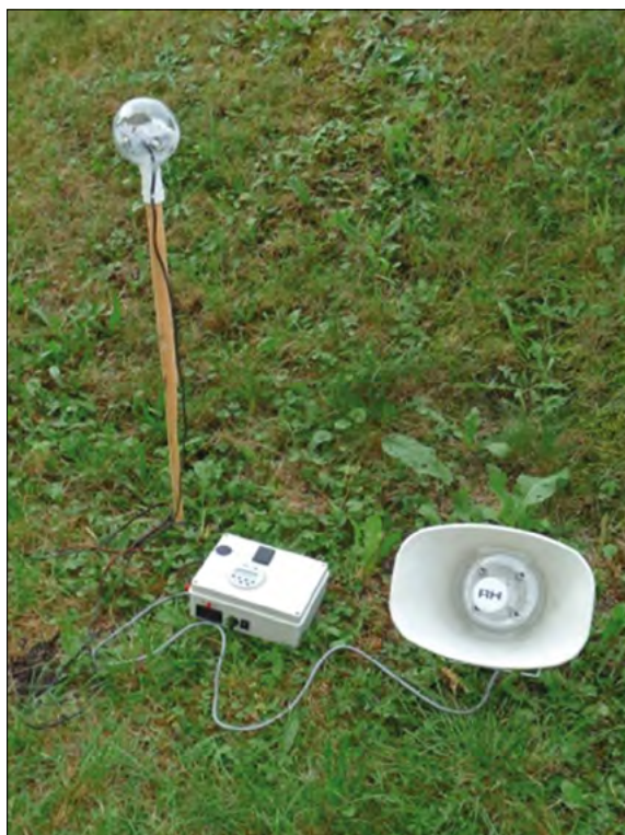
Obr. 27: Opticko-akustický plašič podle návrhu VÚLHM
