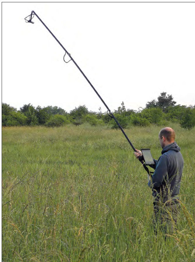
Obr. 39: Vyhledávání srnčat pomocí termovizního vyhledávače VMT-VÚZT
