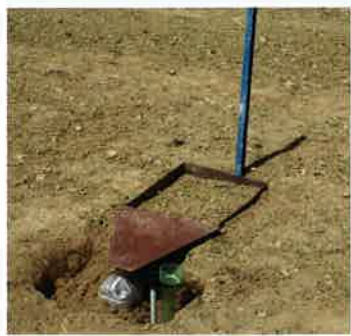
Minisběrač nainstalovaný po zasetí plodiny, kolektor usměrňující odtokovou vodu do sběrné nádoby je překrytý plechem, na každé variantě měření byl úhrn srážky za sledovaném období zachycen instalovaným deštoměrem
