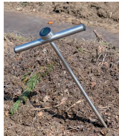
Monitorování kompostovacího procesu - digitální teploměr AGRETO s délkou tyčové sondy 1,5 m. Rozsah měření -50 až +110 °C s přesností ± 1 °C
