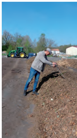
Monitorování kompostovacího procesu - digitální teploměr AGRETO s délkou tyčové sondy 1,5 m. Rozsah měření -50 až +110 °C s přesností ± 1 °C
