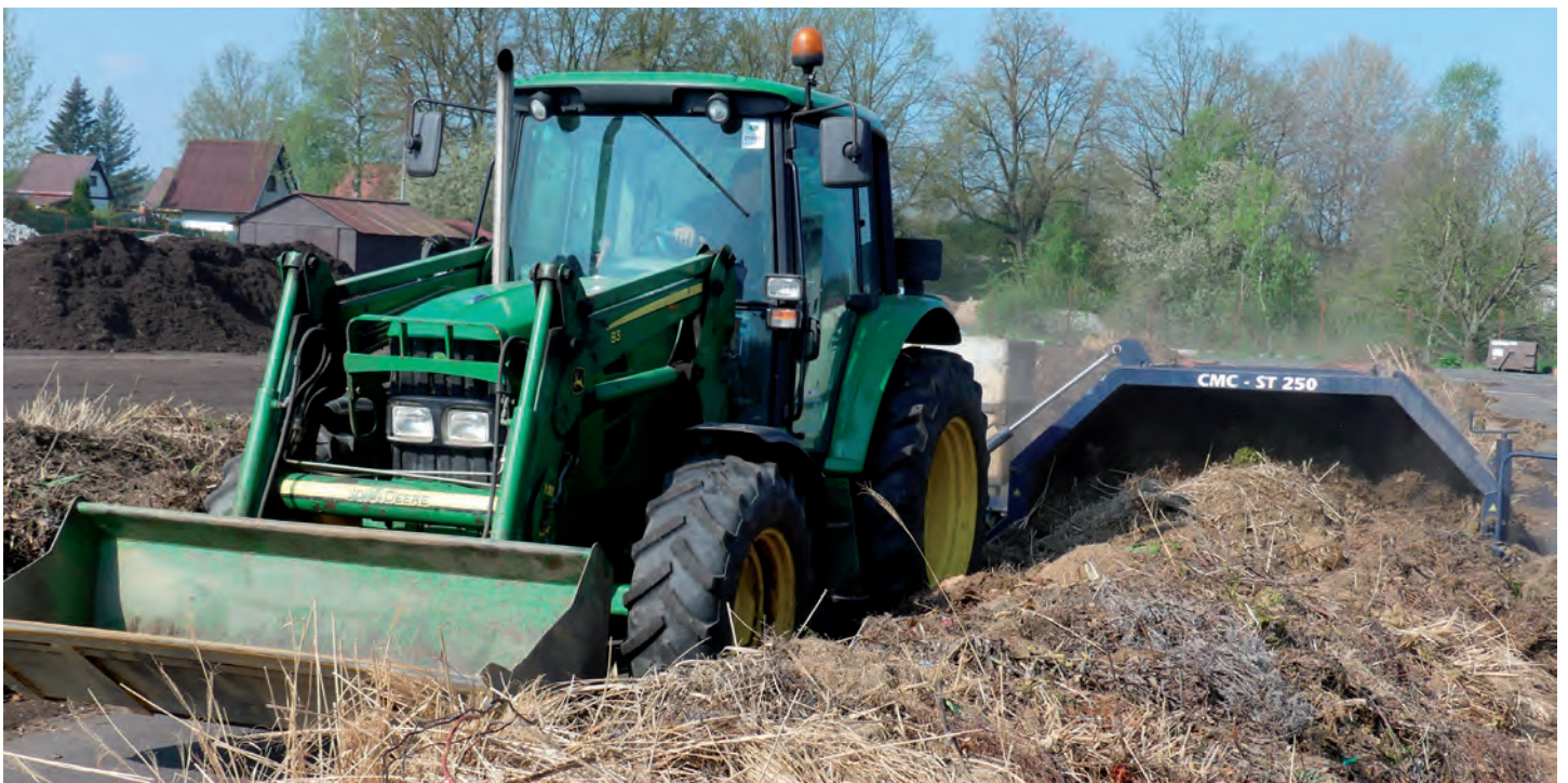
Provozdušňování kompostu – tažený překopávač kompostu COMPOST System CMC – ST 250 s pracovním prostorem (š x v) 2,5 x 1,5 m; výkonnost 500 - 800 m 3 /h podle fyzikálních vlastností zpracovávaných surovin
