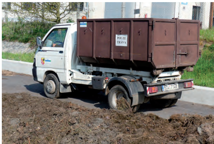
Svoz surovin – užitkové vozidlo Piaggio PORTER S85 s výkonem dieselového motoru 48 kW a nosností 685 kg je vybaveno nástavbou pro svoz kontejnerů. Ocelové kontejnery KOVEX KU 2,6 mají objem 2,6 m 3
