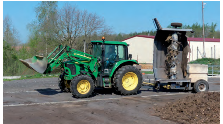
Energetický prostředek - kolový traktor John Deere 6230 L (67 kW) s čelním nakladačem JD 583
