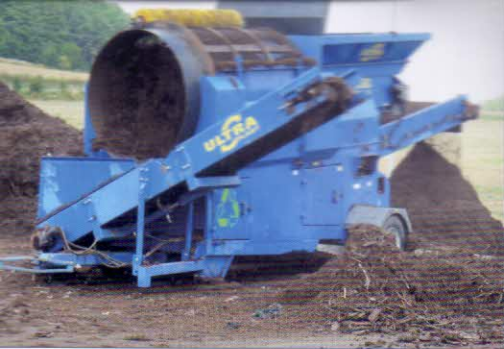
Prosévání kompostu – rotační síto ULTRA T-1500 TROMMEL Screen (diesellový motor 34 kW, násypka 2,2 m 3 , velikost oka síta 300 x 1500 mm)
