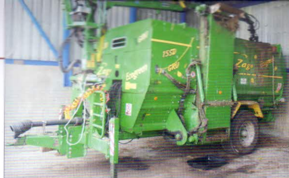
Příprava surovin do zakládky – homogenizátor s drapákem ECOGREEN – ZAGO typ 15SD GRU s objemem pracovního prostoru 3 m 3
