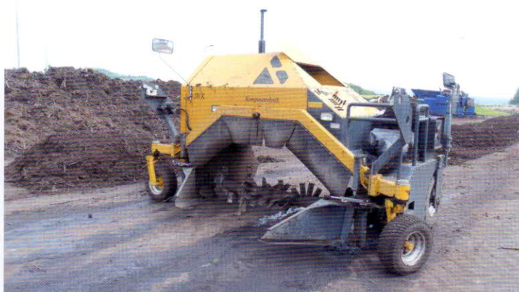
Překopávání kompostu – samojízdný překopávač kompostu Kompost – Technik HRI s diesellovým motorem 48 kW a pracovním prostorem (š x v) 2,7 x 1,5 m
