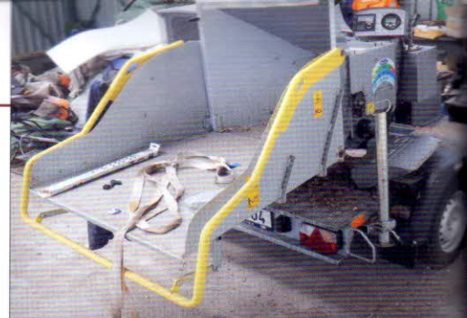
Jemná dezintegrace – drtič dřevního odpadu GALAXY 150 D s diesellovým motorem 25 kW; max. průměr dřevního odpadu 150 mm
