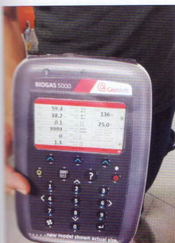
Analýzátor plynů Biogas 5000 (foto: Křížová)
