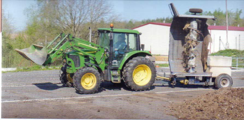
Energetický prostředek – kolový traktor John Deere 6230 L (67 kW) s čelním nakladačem JD 583
