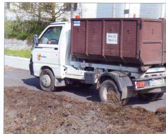
Svoz surovin – užitkové vozidlo Piaggio PORTER S85 s výkonem dieselového motoru 48 kW a nosností 685 kg je vybaveno nástavbou pro svoz kontejnerů. Ocelové kontejnery KOVEX KU 2,6 mají objem 2,6 m 3
