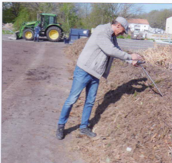
Monitorování kompostovacího procesu - digitální teploměr AGRETO s délkou tyčové sondy 1,5 m. Rozsah měření -50 až +110 °C s přesností ±1 °C
