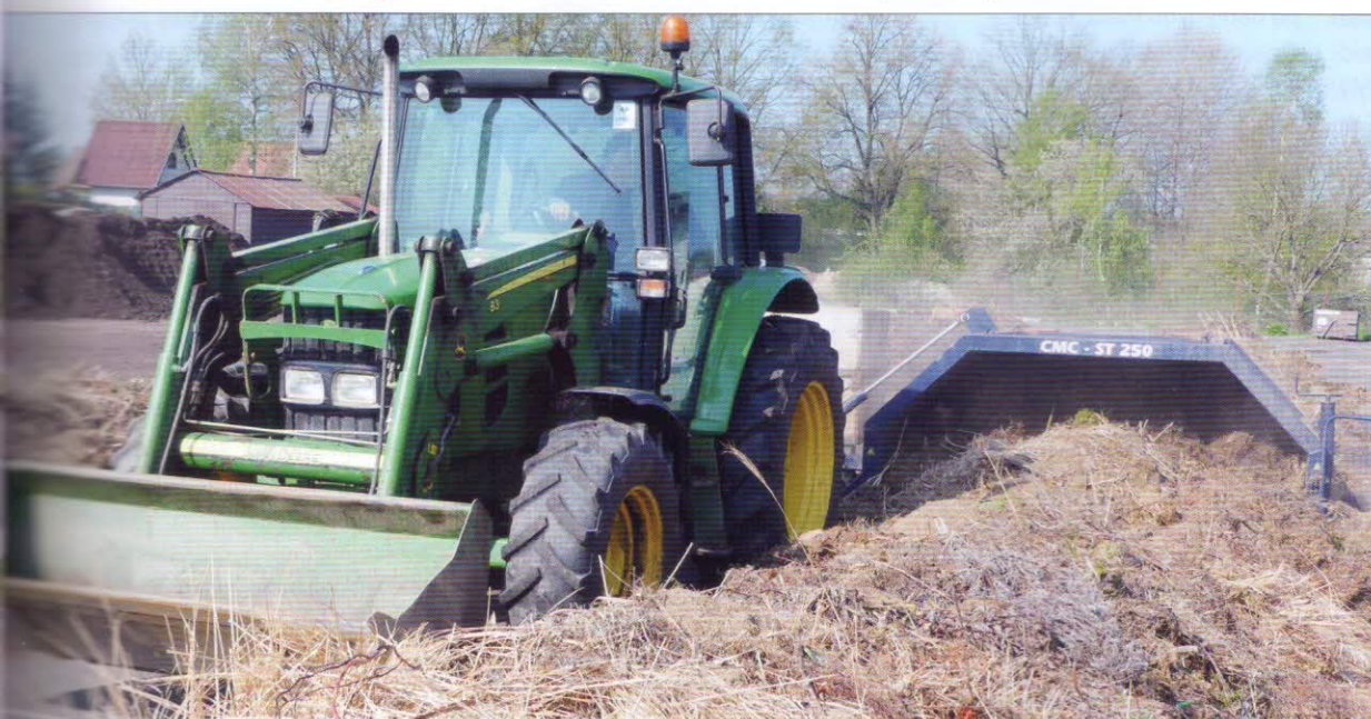
Převážování kompostu - tažený překopávač kompostu COMPOST System CMC - ST 250 s pracovním prostorem (š x v) 2,5 x 1,5 m; výkonnost 500-800 m 3 /h podle fyzikálních vlastností zpracovávaných surovin
