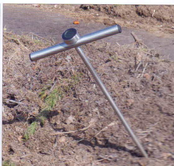
Monitorování kompostovacího procesu - digitální teploměr AGRETO s délkou tyčové sondy 1,5 m. Rozsah měření -50 až +110 °C s přesností ±1 °C
