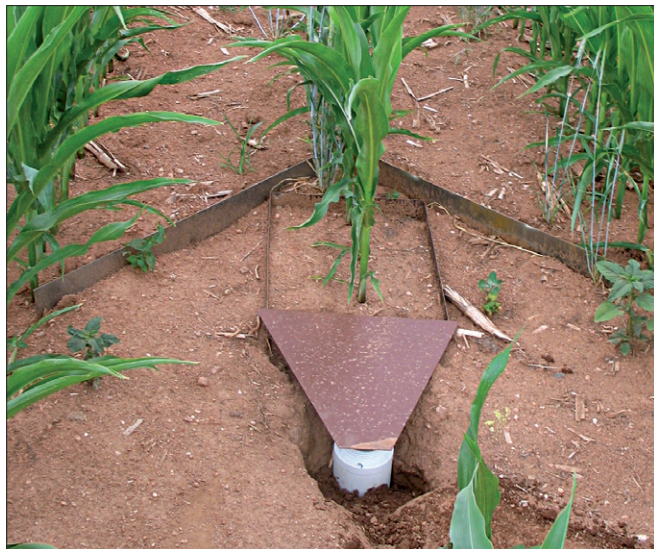
Obr. 2. Minisběrač povrchového odtoku umístěný v řádku kukuřice – nad každým minisběračem ve směru proti svahu byly umístěny ochranné plechy, které zabraňují zaplavení minisběračů vodou stékající po svahu v případě intenzivního deště
