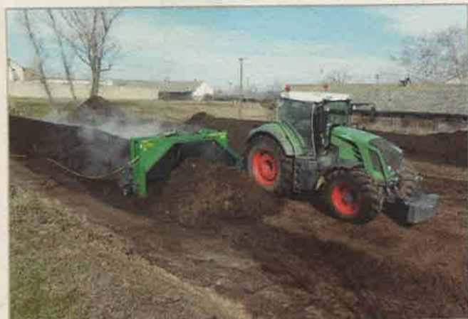
Překopávání kompostu – překopávač kompostu K 3000 IWK Maschinenbau, GmbH, má pracovní prostor 3 x 1,7 m, výkonnost 900 m 3 /h (podle fyzikálních vlastností zpracovávaných surovin) Foto Petr Plíva
