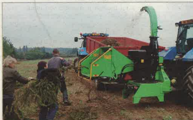
Jemná dezintegrace – štěpkovač za traktor Laski LS 200 T, max. průměr dřeva 200 mm, výkonnost 10–15 m 3 /h. Velké množství materiálu se zpracovává formou služby rychloběžným drtičem Doppstadt AK 235
