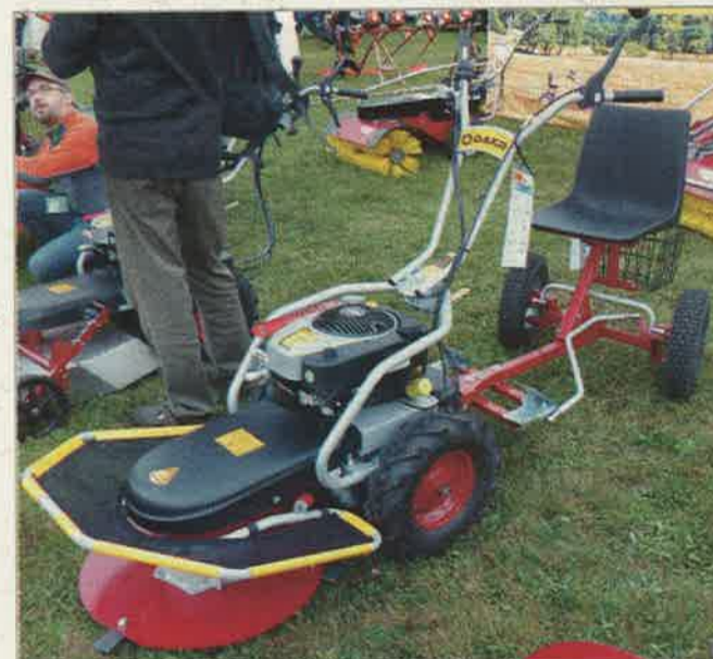
Pro jednonápravové malotraktory a nosiče se jako příslušenství dodávají různá provedení tzv. sulky
