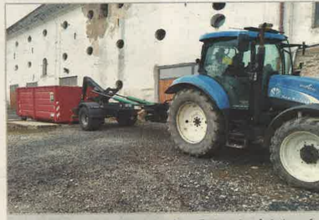
Sběr a přeprava BRKO – traktorové nosiče kontejnerů. Jednoosý hákový nosič kontejnerů FORNAL 10 t, dvouosý hákový nosič kontejnerů ITRunner 24 t Foto Petr Plíva
