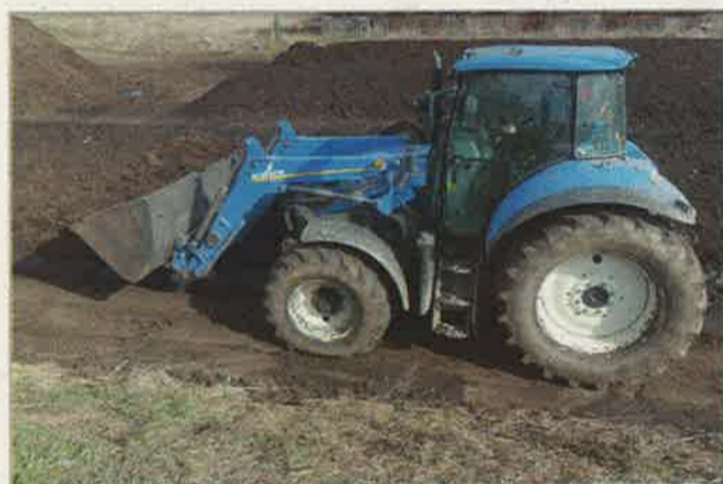
Manipulace se surovinami – kolový traktor New Holland T5.115 (85 kW) s velkoobjemovou lopatou (1,2 m 3 ), lopata s přičytem – 0,7 m 3
