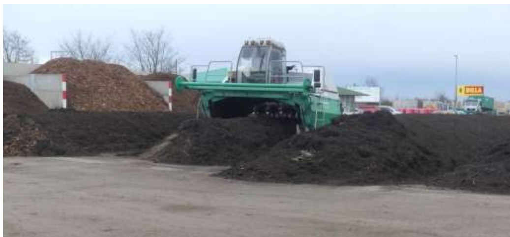
Obr. 2: Kompostování na volné ploše v pásových hromadách
