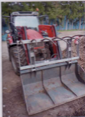
Manipulace se surovinami – čelní nakladač 946, objem lopaty 1,0 m 3
