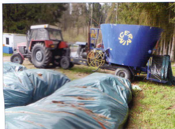
Promíchávání a homogenizace surovin, plnění kompostovacích vaků – mobilní kompostárna CERNIN MK 7, náhon traktoru min. 66 kW, objem pracovního prostoru 7,0 m 3 , výkonnost – 42 m 3 /h
