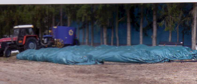
Kompostovací vaky EURO BAGGING, materiál LDPE, délka max. 60 m, průměr 1,5 m, úložná kapacita vaku zhruba 60 t
