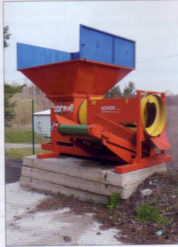
Prosévání kompostu – bubnová prosévačka substrátu NOVER BPS 02 s elektromotorem 2,95 kW; velikost oka síta 20 x 20 mm, výkonnost 15–25 m 3 /h (podle fyzikálních vlastností zpracovávaných surovin)
