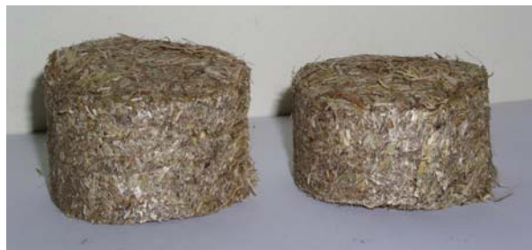
Obr. 4: Brikety vyrobené ze slámy z technologického odpadu
