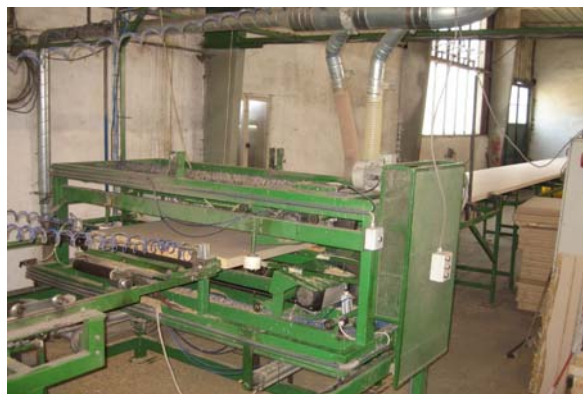
Obr. 2: Pás ekopanelu s formátovacím zařízením
