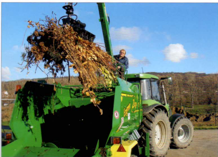
Homogenizace a promíchávání zpracovávaných surovin – drtič biomasy ECOGREEN Zago 07SD GRU
