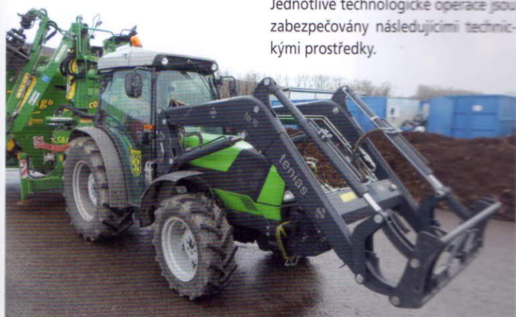
Energetický prostředek – kolový traktor DEUTZ-FAHR AGROPLUS F 420 Synchro (69,9 kW) s čelním nakladačem TENIAS te 10
