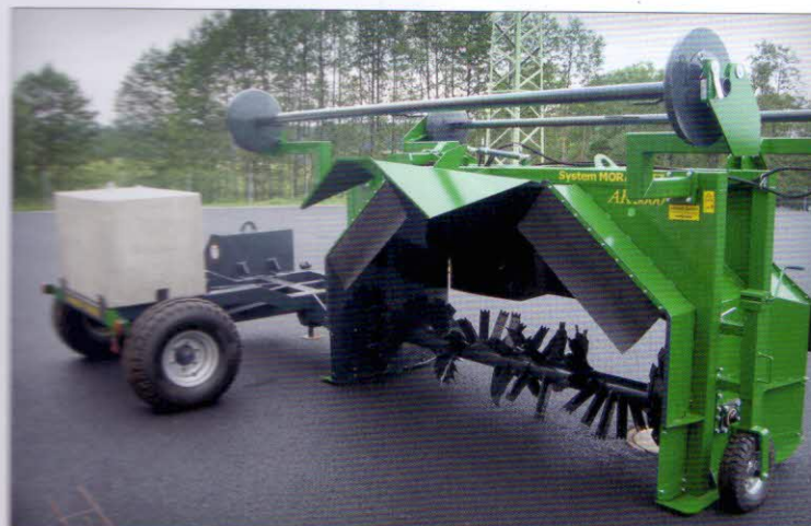
Překopávání kompostu – tažený překopávač kompostu Kompost – Technik AK 2500 s pracovním prostorem 2,5 x 1,87 m
