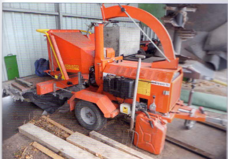
Jemná dezintegrace – štěpkač biomasy CARAVAGGI Cippo 15 (teoretická výkonnost 10 m 3 /h)
