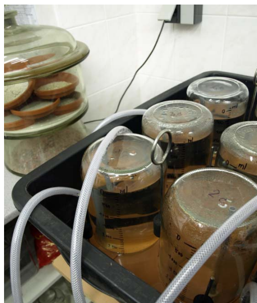
Obr. 2: Detail plynojemů na zachycení plynu
