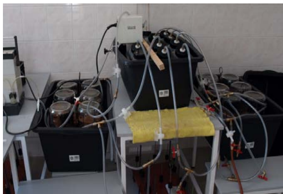
Obr. 1: Pokusné zařízení s fermentory a plynojemy
