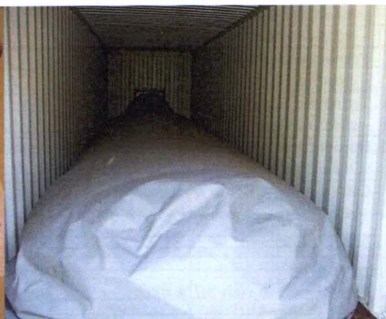
Obr. 4: Kontejnerové uložení skladovacího vaku vyrobeného T-bioplynu ve zkušební jednotce PTR
