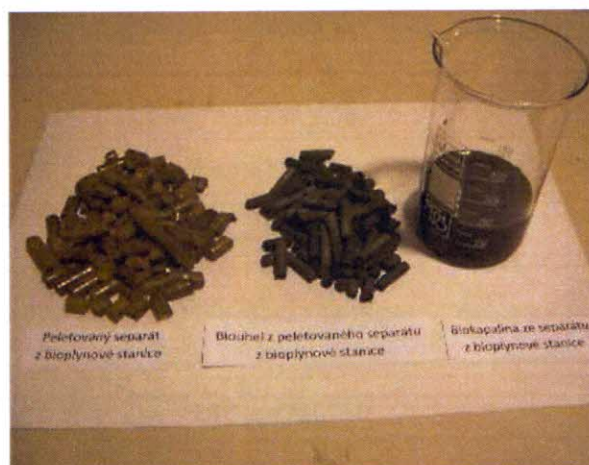
Obr. 3: Peletovaný separát z bioplynových stanic a z něho vyrobené biouhly a biokapalina – bio-olej ve zkušební jednotce PTR
