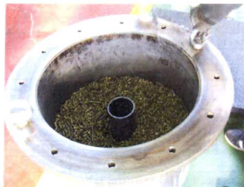
Obr. 2: Palivový článek zkušební jednotky PTR se vsázkou peletovaného separátu z bioplynových stanic
