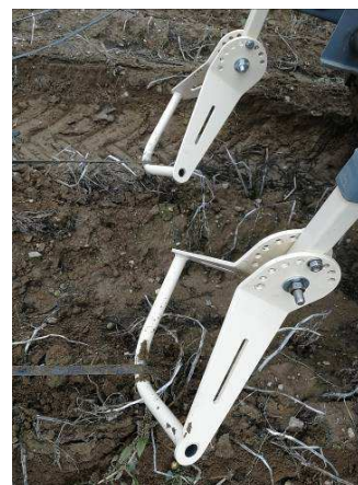
Obr. 22 Vlevo: detail uložení kapkovacích hadic v hrůbku. Vpravo: jednoduché zařízení pro vytahování hadic z hrůbků před sklizní.
