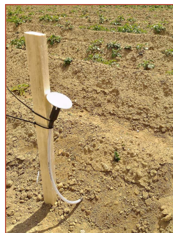
Obr. 13 Instalace vlhkostního a teplotního čidla na lokalitě Okrouhlice – Vadín
