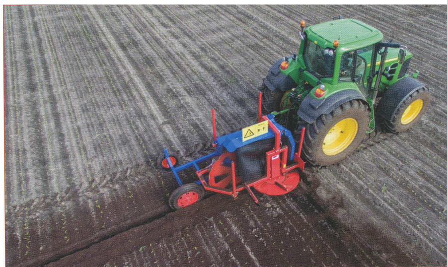
ZIBO Gruppenfrase mit horizontal verstellbar breitstreuaggregat (hydr. antrieb) (SF0335) und Stützrad (SF0615)
