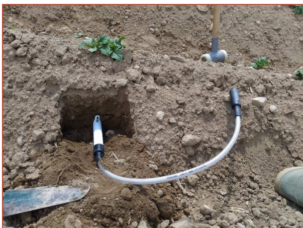
Obr. 13 Instalace vlhkostního a teplotního čidla na lokalitě Okrouhlice – Vadín
