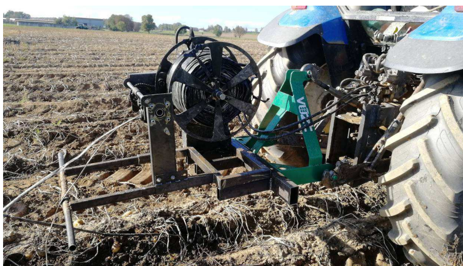
Obr. 23 Testování funkčního vzoru zařízení pro opětovné navíjení hadic z hrůbku brambor po ukončení vegetace před sklizní
