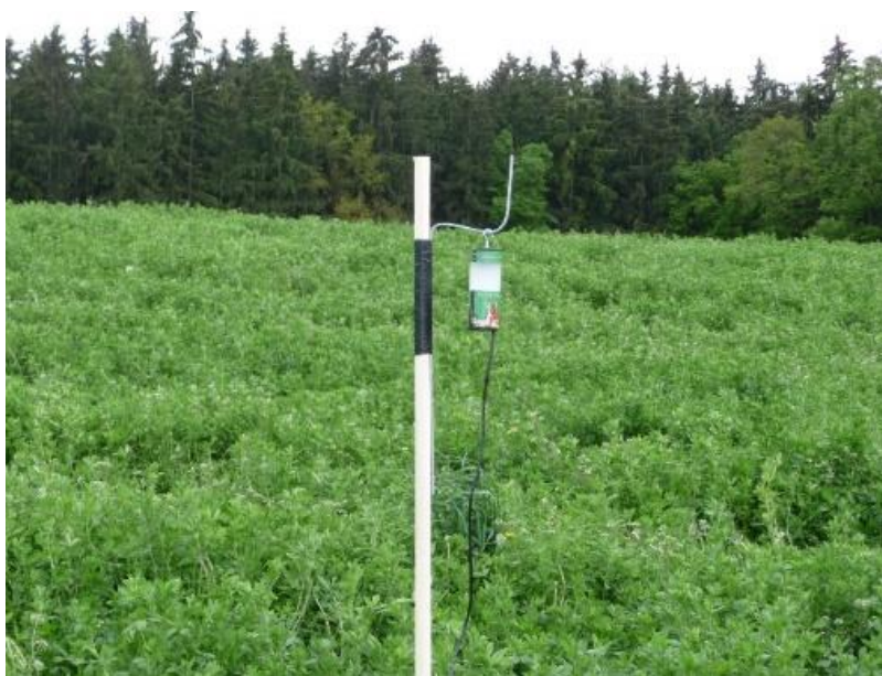
Obr. 26 Programovatelný akusticko-optický plašič německé výroby
