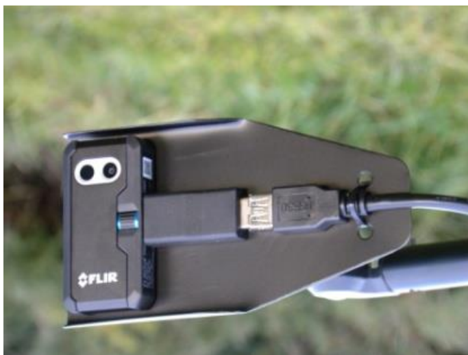
Obr. 42 Termokamera FLIR ONE na zařízení VMT-VÚZT
