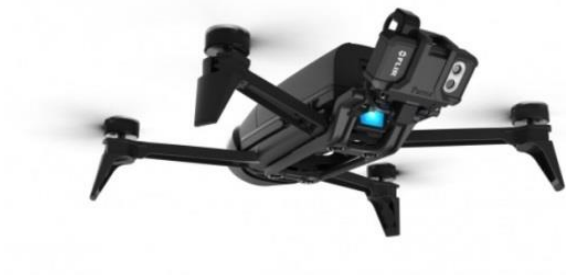
Obr. 52 Dron Parrot Bebop-Pro Thermal s termokamerou FLIR ONE Pro
