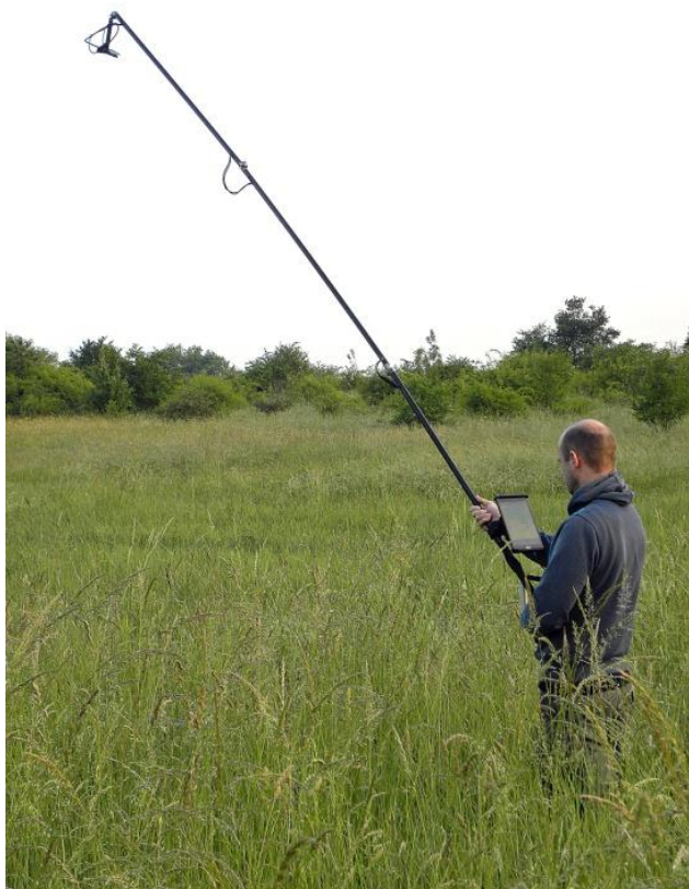
Obr. 39 Vyhledávání srnčat pomocí termovizního vyhledávače VMT-VÚZT
