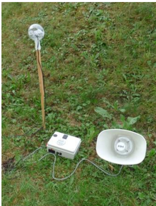
Obr. 27 Opticko-akustický plašič podle návrhu VÚLHM
