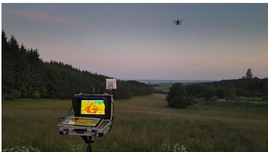
Obr. 49 Ukázka zobrazení obrazu z termovizního systému pod letícím dronem v reálném čase
