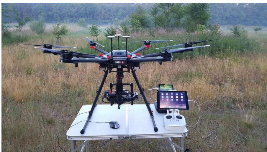
Obr. 53 Velká multikoptéra s termovizním systémem Wiris
