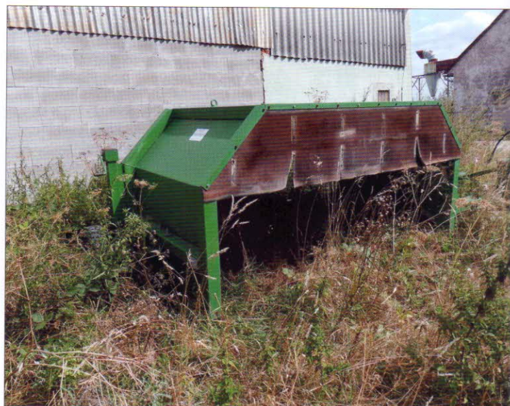
Překopávání kompostu – překopávač kompostu RIVO-280 KL v agregaci s kolovým traktorem Massey Ferguson MF 7718 D6. Pracovní prostor překopávače (š x v) – 2,8 x 1,6 m, výkonnost 750–900 m 3 /h (podle fyzikálních vlastností zpracovávaných surovin)
