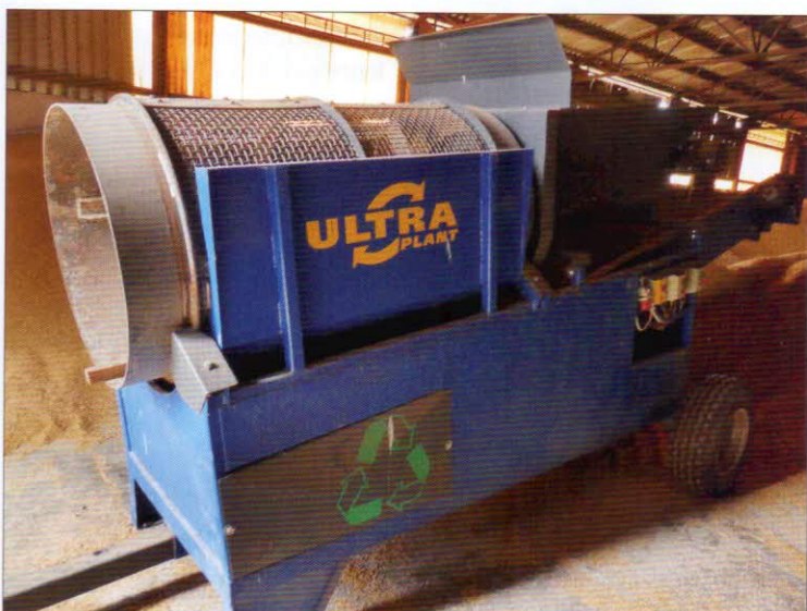
Prosévání kompostu – bubnový síťový třídič ULTRA SCREEN 1000 MINI s elektrickým motorem 6 kW, výkonnost asi 5 t/h
