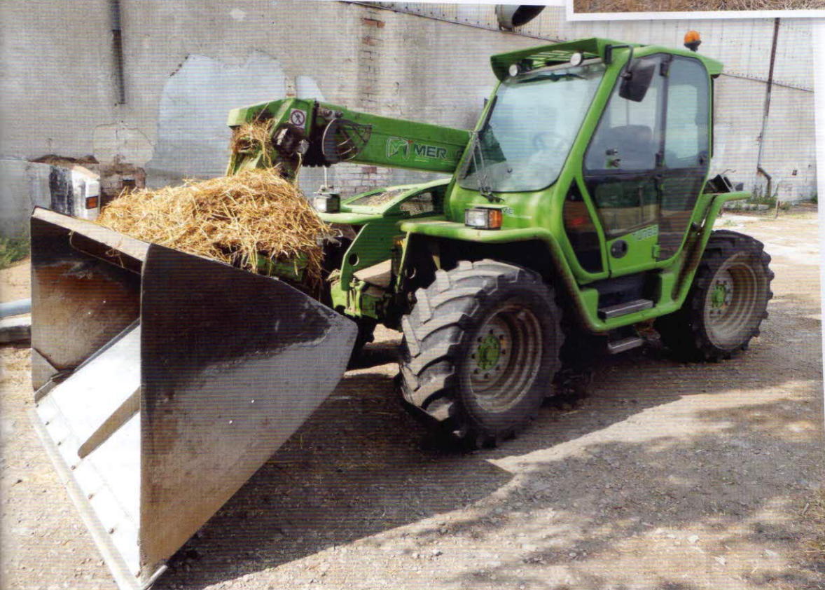
Manipulace se surovinami - manipulátor Merlo s dieselovým motorem 103 kW a objemem čelní lopaty 1,2 m 3
