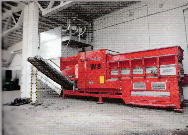
Úprava surovin po I. fázi kompostování - vzduchový třídič Terra Select W 8, příkon elektromotoru 45 kW a objem pracovního prostoru 6 m 3
