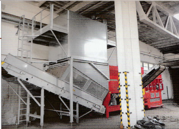
Úprava surovin po I. fázi kompostování - vzduchový třídič Terra Select W 8, příkon elektromotoru 45 kW a objem pracovního prostoru 6 m 3
