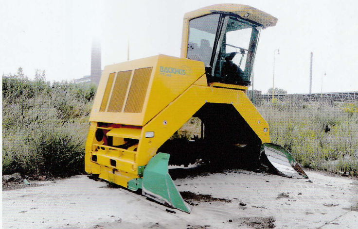
Překopávání kompostu - samojízdný překopávač kompostu BACKHUS 17,43 se vznětovým motorem (209 kW)
