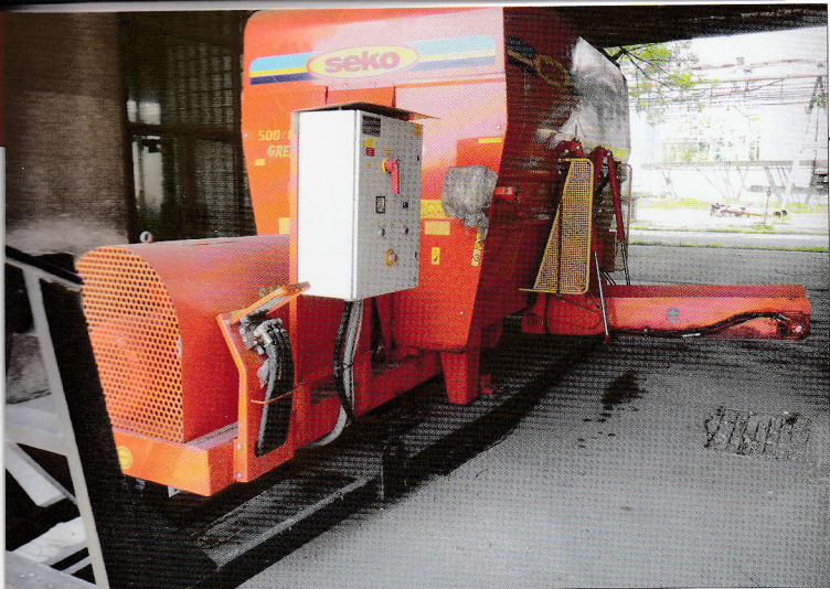
Stroje pro kompostování gastroodpadů (fermentor EWA, míchací stroj SEKO)
