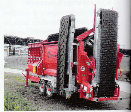
Prosévání kompostu – mobilní bubnový třídící Terra Select T4E (výkonnost max. 100 m 3 /h)
