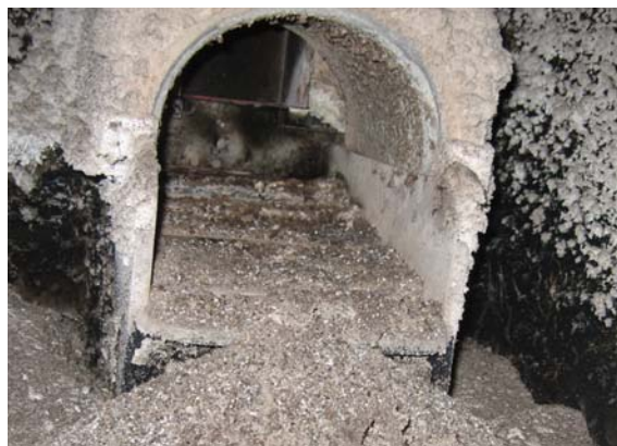
Obr. 3: Pohled na hořák po dlouhodobých zkouškách
