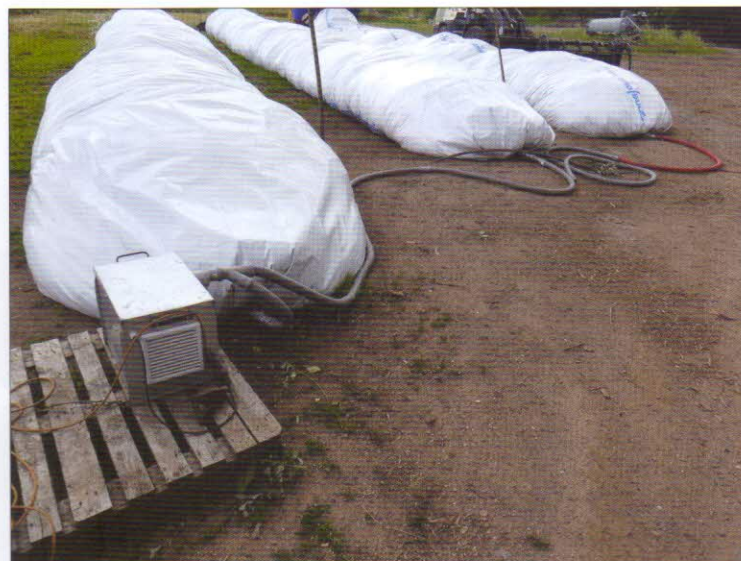
Systém pro provzdušňování – ventilátory s řídicí jednotkou zajišťují regulované provzdušňování, provzdušňovací hadice s průměrem 50 mm a délkou 50 m, opakovaně použitelné vestavěné ventilační průduchy
