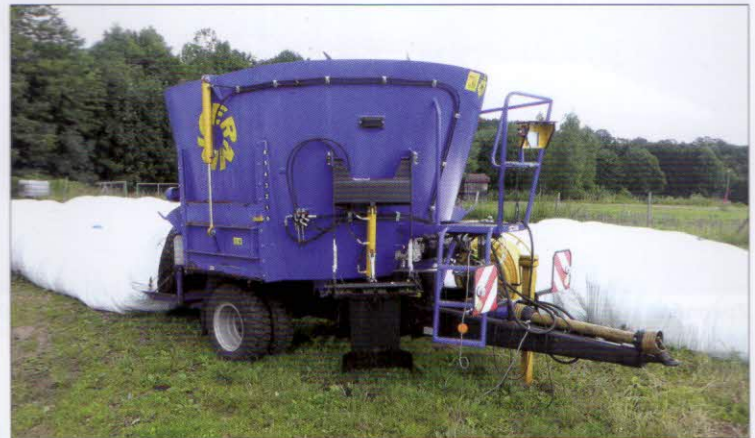
Promíchávání a homogenizace surovin, plnění kompostovacích vaků – mobilní kompostárna MK 9 Cernin. Energetický zdroj – kolový traktor Zetor Proxima (100 kW)
