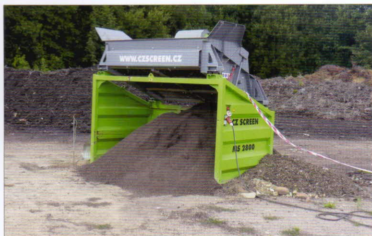
Prosévání kompostu – tříděč MS 2800 CZ Screen s elektromotorem 1,1 kW pracuje s výkonem 40 až 80 t/h
