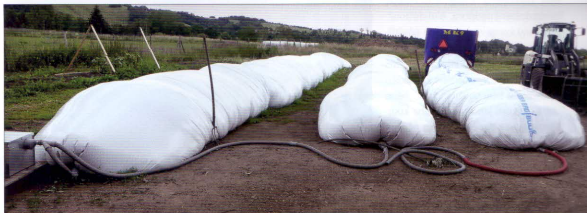
Kompostovací proces – kompostovací vaky (délka 30–45 m, průměr 1,5 m)
