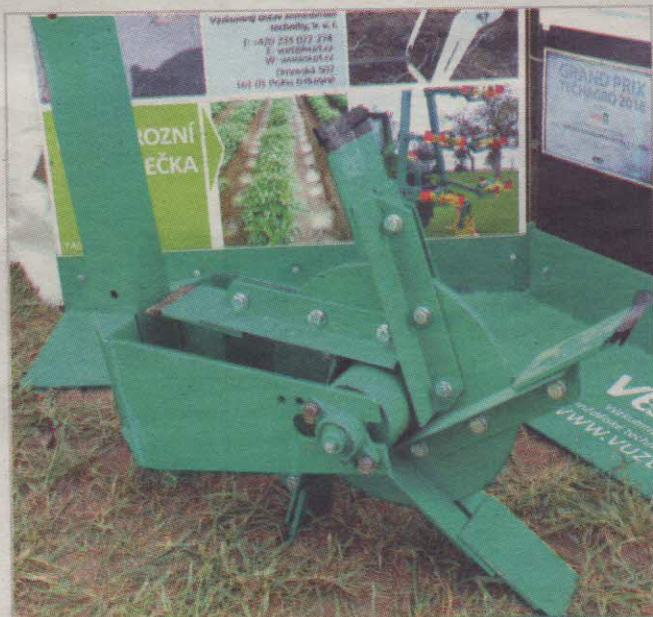
Modul určený k podpoře akumulace vody v brázdách a snížení povrchového odtoku
