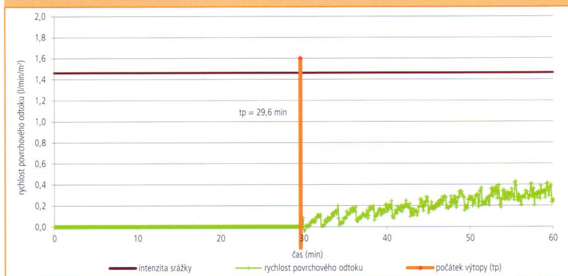
Graf 5 – Rychlost povrchového odtoku při měření simulátorem deště koncem dubna v ozimé pšenici – mimo kolejové stopy
