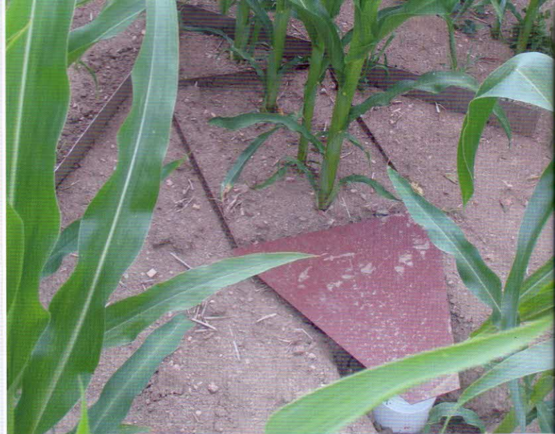
Minisběrač instalovaný v porostu kukuřice
