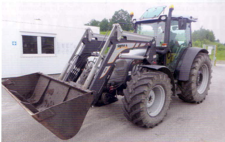
Energetický prostředek – kolový traktor Lamborghini R3 EVO 100 s dieselovým motorem 72,5 kW. Je vybaven čelním nakladačem Sigma 4 Gold M20 s objemem lopaty 0,60 m 3
