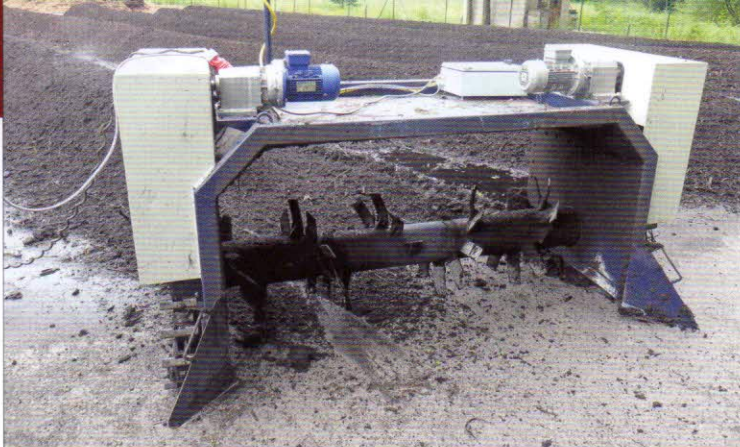
Překopávání kompostu – samojízdný překopávač kompostu COMPOST SYSTEMS CMC SF 200 s pracovním prostorem 2 x 1 m a výkonností zhruba 300 m 3 /h (závisí na vlastnostech překopávaných surovin)
