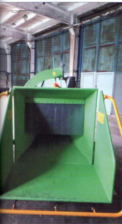
Jemná dezintegrace – štěpkovač za traktor Negri bio LS 150 T (výkonnost 7–12 m 3 /h podle vlastností surovin). Maximální průměr štěpkovaných větví 160 mm
