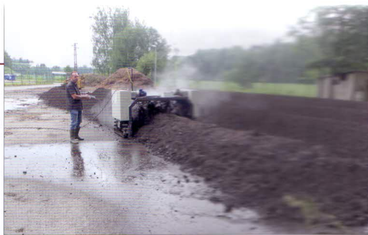
Řízení samojízdného překopávače kompostu
