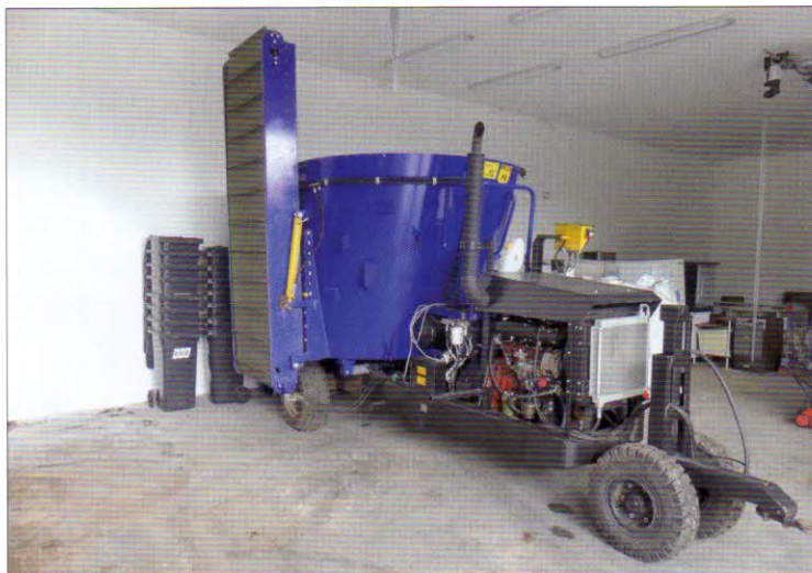
Promíchávání a homogenizace surovin – dezintegrátor BRO Cernin MK 7 s objemem pracovního prostoru 7 m 3 (výkonnost 42 m 3 /h podle vlastností surovin)
