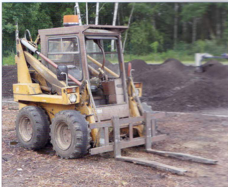
Manipulace se surovinami – smykem řízený nakladač LUNC – 060 (výkon motoru 34,2/33,1 kW, pojezdová rychlost – 12 km/h, objem lopaty – 0,35 m 3 , příslušenství – nakládací vidle)
