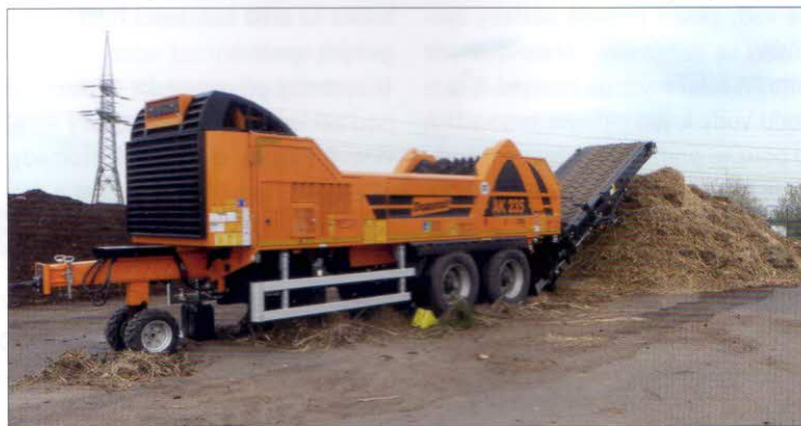
Jemná dezintegrace – rychloběžný drtič Doppstadt AK 235 s dieselovým motorem 175 kW. Drtičí buben – 32 kladív (2 řady po 16 kladívech), dodrčovací síto s oky 20 x 20 mm
