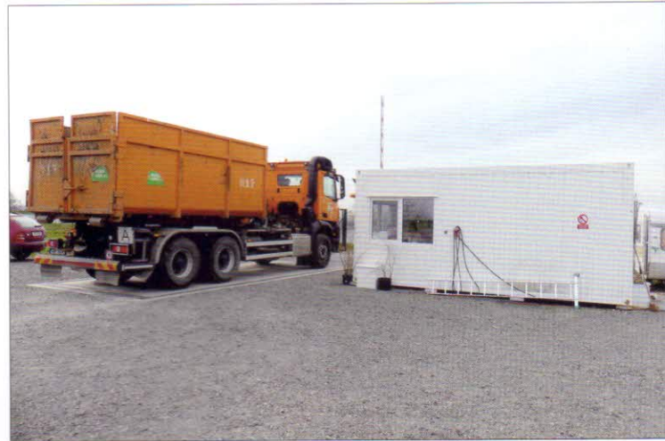
Evidenci přijímaných surovin – silniční mostní nájezdová váha Gravex GX22AL ocelové konstrukce má rozměry vážicí plošiny 8 x 2,5 m; váživost do 30 000 kg s přesností ±10 kg
