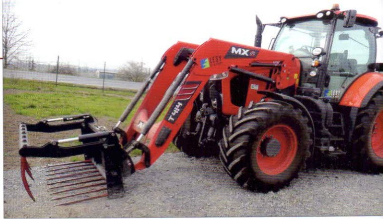
Energetický prostředek, manipulace se surovinami – kolový traktor Kubota M7171 (129 kW) s lopatou 0,6 m 3 a lopatou s přídržovačem 1,0 m 3
