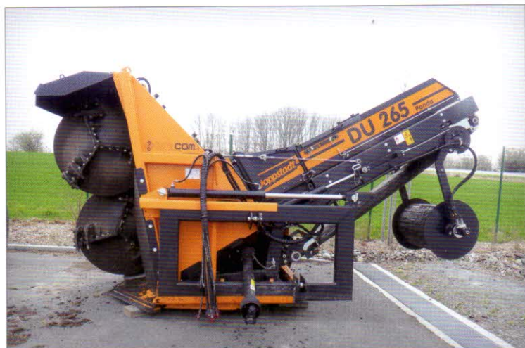
Překopávání kompostu – tažený překopávač kompostu Doppstadt DU 265 – Panda s pracovním prostorem 5 x 3 m, výkonnost dosahuje 300 m 3 /h
