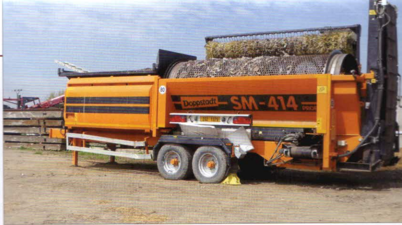
Prosévání kompostu – bubnový třídící Doppstadt SM 41 s vlastním motorem (30 kW)
