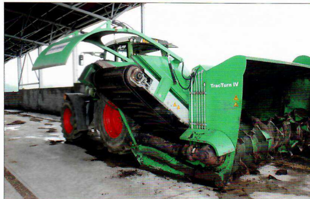
Překopávání je zajištěno překopávačem TracTurn IV. Stroj se záběrem 3,7 m (pracovní výška 2,3 m) může pracovat nezávisle na tvaru zakládky a dosahuje výkonu 2000 m 3 /h
