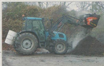
Obr. 7 - Třídící a drtič lopata Allu při prosévání kompostu
