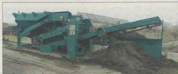
Obr. 1 – Vibrační třídíče s rovinným sítím a vynášecím dopravníkem Foto Petr Pliva
