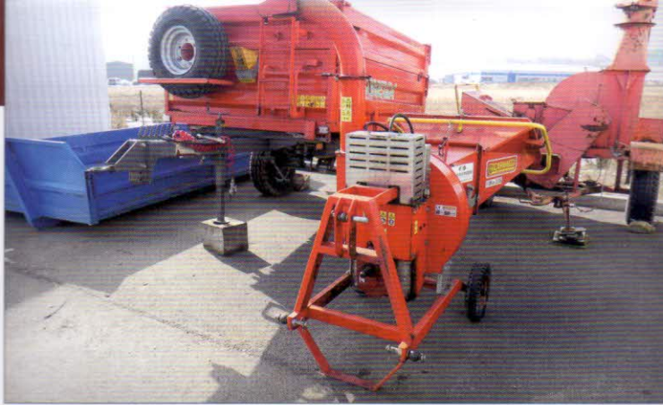
Jemná dezintegrace – štěpkovač CARVAGGI 235 s max. průměrem zpracovávané suroviny 75 mm
