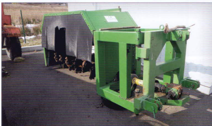
Překopávání kompostu – překopávač kompostu NPK 200 s pracovním prostorem 2000 x 1300 mm
