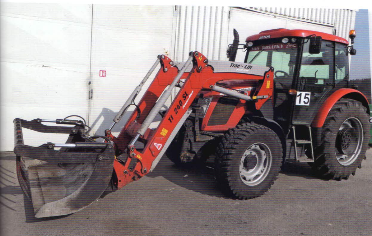
Energetický prostředek + manipulace se surovinami – kolový traktor ZETOR PROXIMA 90 (64 kW) s čelní lopatou (0,56 m 3 ) TRAC-LIFT, TL 240 SL
