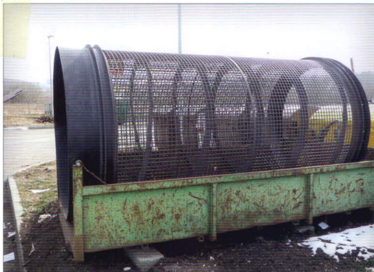
Bubnová síta s rozměry ok 20 x 20 mm (vlevo) a 80 mm (vpravo)
