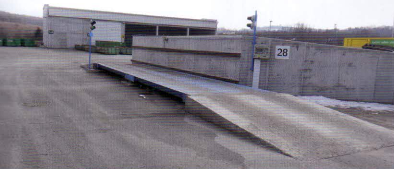
Evidence přijímaných a expedovaných surovin – stacionární silniční nájezdová váha RODAN VT ocelové konstrukce s váživostí 200–30 000 kg a přesností ±10 kg
