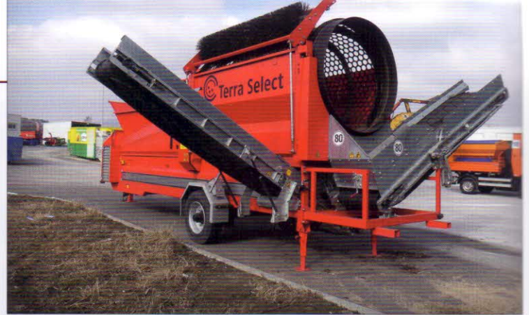
Prosévání kompostu - bubnový síťový třídič TERRA T3 s dieselovým motorem 21,5 kW a výkonností 20–50 m 3 /h
