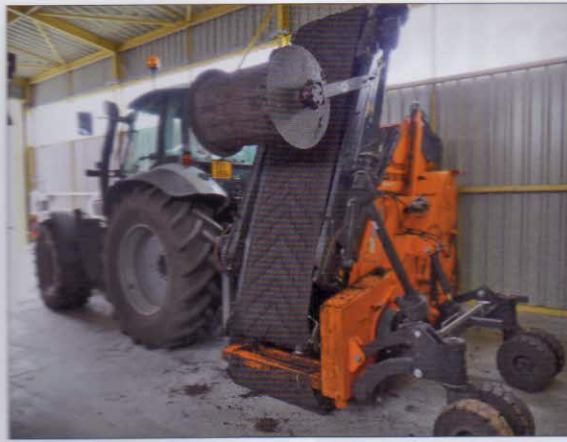
Překopávání kompostu – tažený překopávač kompostu Doppstadt DU 265 – Panda. Energetický zdroj – kolový traktor, pracovní prostor 5 x 3 m a výkonnost 300 m 3 /h
