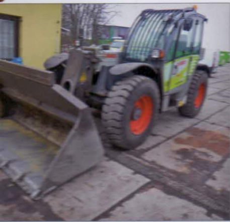
Manipulace se surovinami – teleskopický manipulátor Class 7045 plus Scorpion s dieselovým motorem 103 kW, nosností – 4400 kg, objemem lopaty 1,8 m 3 a výškou zdvihu 7,30 m
