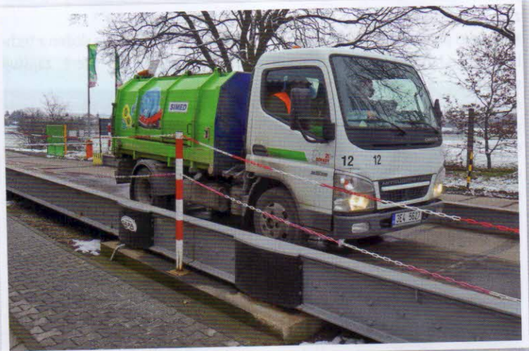
Evidenční příjímání surovin – silniční nájezdová váha ocelové konstrukce s váživostí do 60 000 kg a přesností ±20 kg
