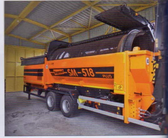
Prosévání kompostu – bubnový třídič Doppstadt SM 518 (výkon 54 kW) s násypkou 3 m 3 a bubnem s oky 20 x 20 mm
