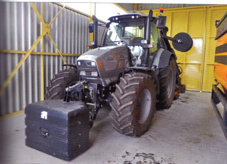
Energetický prostředek – kolový traktor Lamborghini R6.160 T4i, výkon motoru 120 kW
