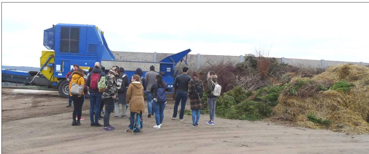
Obr. 3: Jemná dezintegrace - mobilní drtič HUSMANN HGF IV
