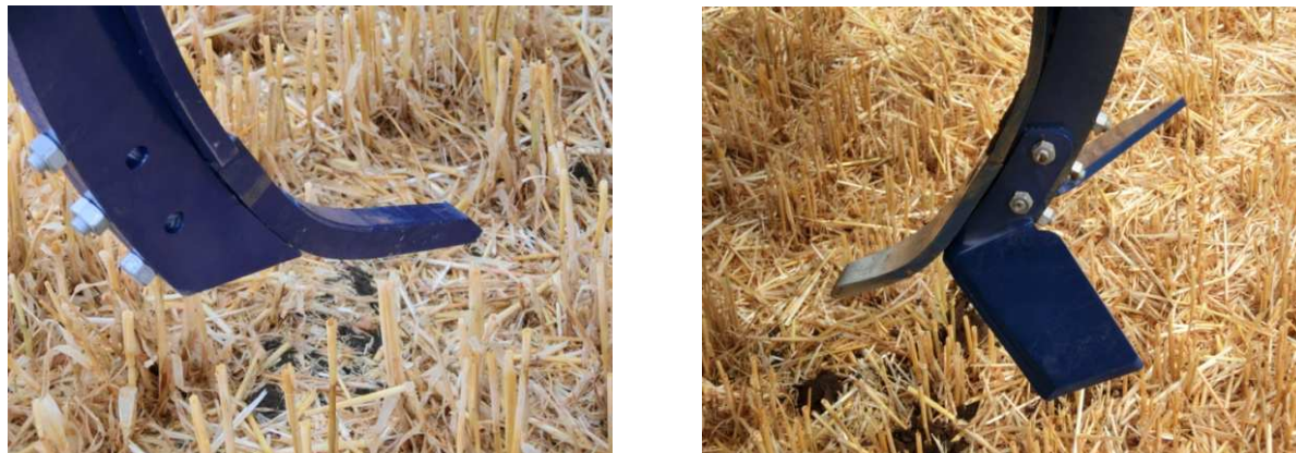
Obr. 20 Kypřicí těleso s jednoduchým dlátem (vlevo), kypřicí těleso s dlátem o šířce 75 mm a bočními křídly (vpravo)
