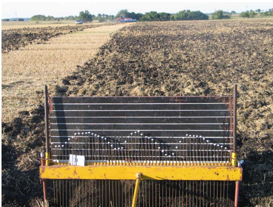
Obr. 39 Profil dna zpracované vrstvy půdy – Terrix Dual 600 PS, zahloubení 250 mm
