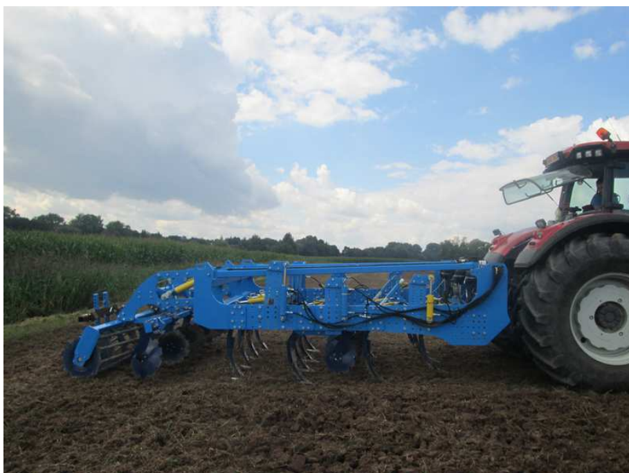
Obr. 36 Funkční model dlátového kypřiče Terrix Dual, osazený 4 řadami dlát s křídly, za 2. a 4. řadou dlát s rovnacími talíři a vzadu s prutovým válcem pro drobení hrud
