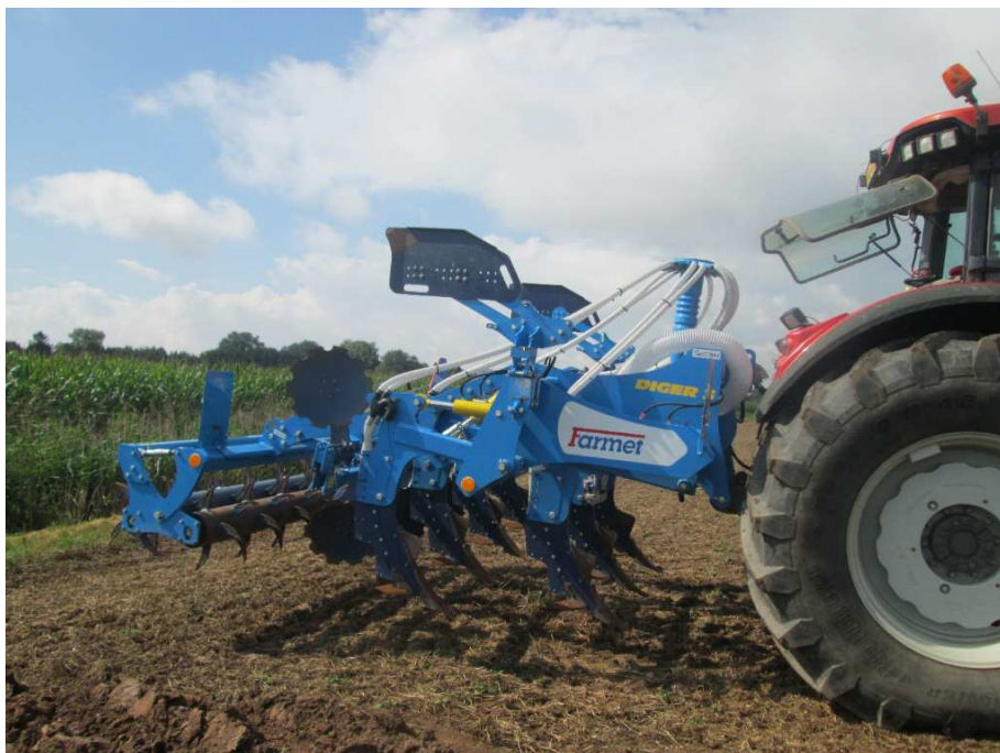
Obr. 35 Hloubkový kypřič Digger 3, osazení 2 řadami dlát s křídly, řadou rovnacích talířů a dvojitým hrotovým válcem pro drobení hrud
