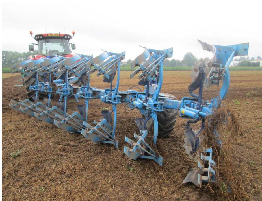
Obr. 34 Návěsný 7-radličný oboustranný pluh Farnet Vidium P 350 Vario s páskovými odhrnovačkami
