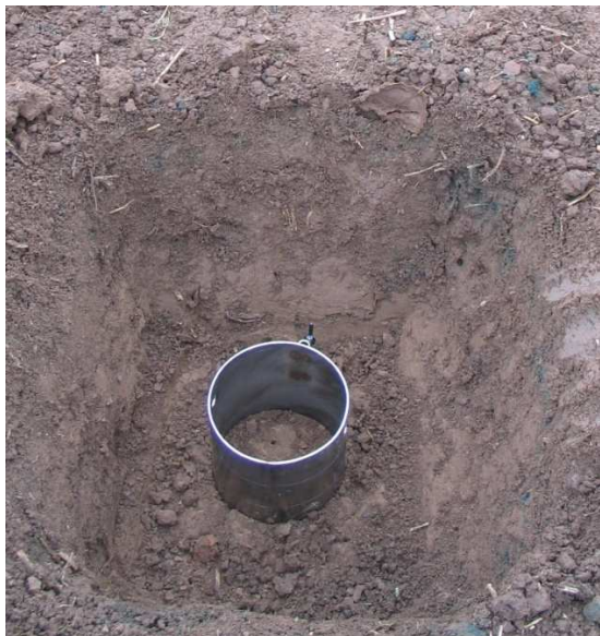
Obr. 25 Měřicí válec spodní hranou zatlučený do hloubky 50 mm před měřením v hloubce 300 mm
