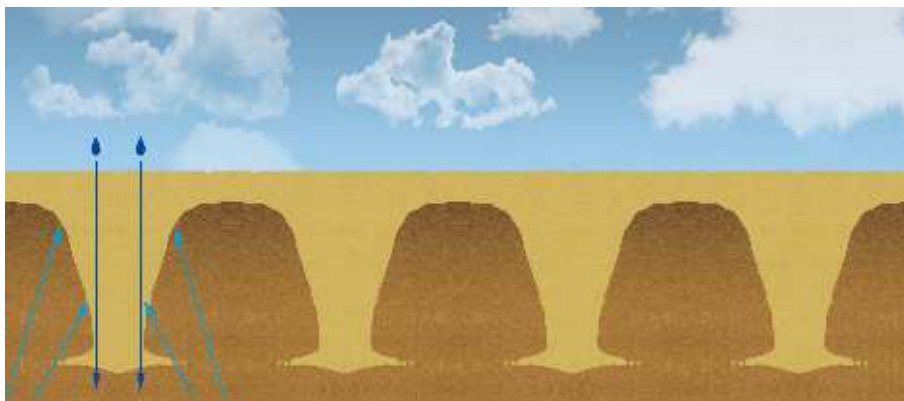
Obr. 5 Zónově prokypřená půda s podpovrchovými nezpracovanými hrůbkami. Srážková voda hluboko vsakuje v místě prokypřených zón (tmavě modré šipky). V místě nezpracovaných podpovrchových hrůbků půdní vláhla velmi dobře vzlíná vysoko ke kořenům (světle modré šipky).
