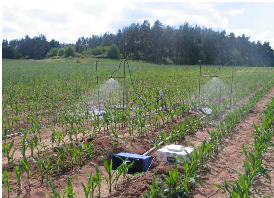
Obr. 17 Měření povrchového odtoku simulátorem deště v porostu kukuřice
