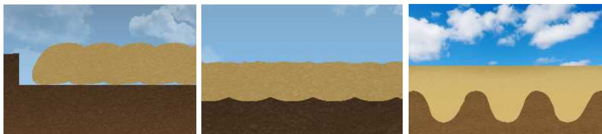
Obr. 4 Orba se zcela plochým dnem brázdy (vlevo), celoplošné kypření se skoro plochým dnem (uprostřed) a zónové kypření s podpovrchovými nezpracovanými hrůbky (vpravo).
